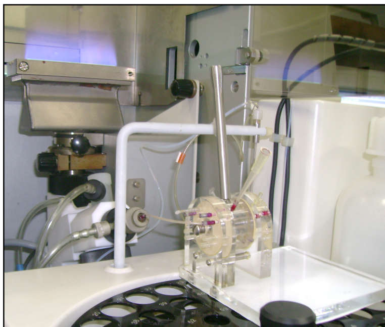
Figura 29: Fotografia do injetor-comutador acoplado ao tubo de aspiração do nebulizador para a inserção dos extratos nas determinações por FAAS.
