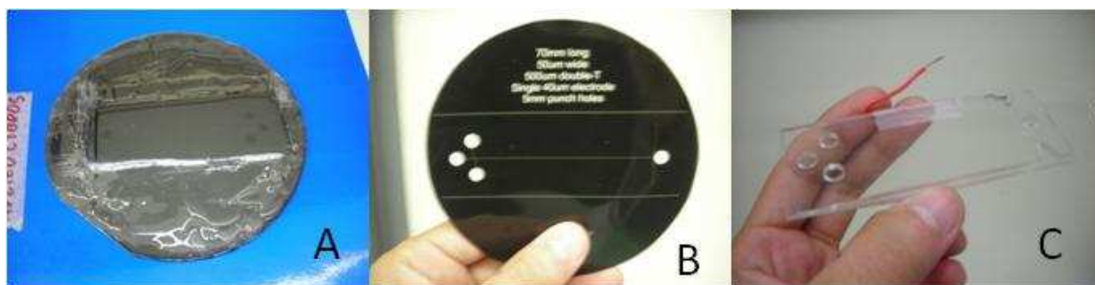
Figura 42 : A- molde do chip, B- máscara com o desenho dos canais, C- chip pronto
