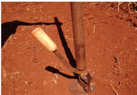
FIGURA 3: Extrator de solo Modelo H.R.S -2006 para a coleta das amostras de solo.
