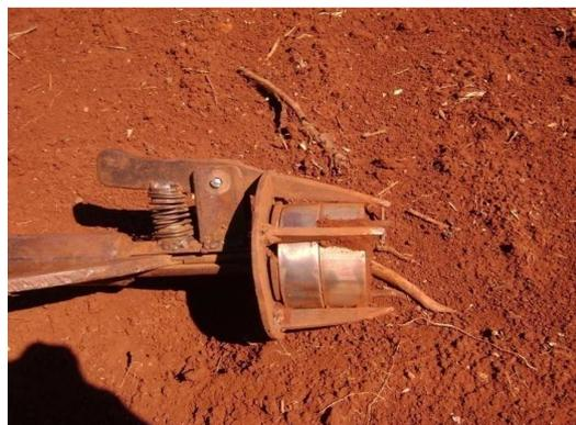
FIGURA 4: Amostras de solo retiradas a profundidade de 0 a 5 cm, com anéis de 2,5 cm de altura.
