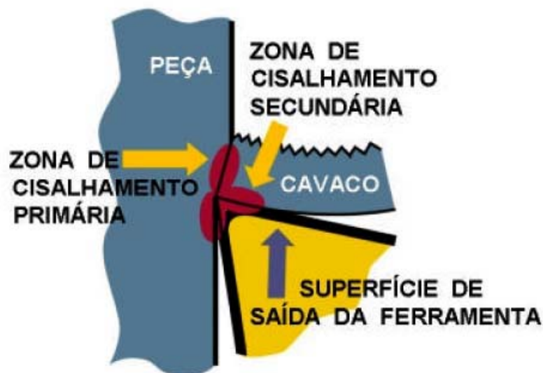
Figura 2.2 - As diferentes zonas de formação do cavaco. Fonte: Adaptado de Sandvik Coromant (2000).
