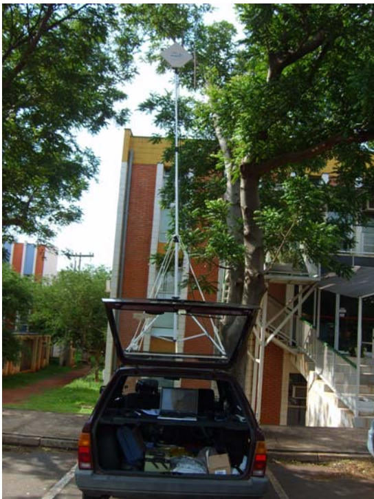
Figura 16 - Antena e equipamentos montados no carro de testes
