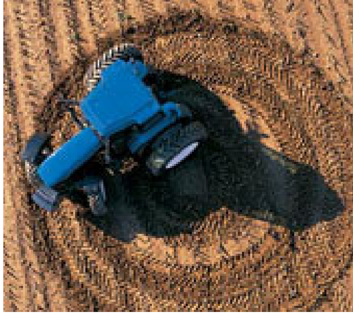
Figura 2.1.2.2- Modelo da CNH produzido com eixo sobre-esterçante.
