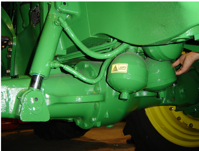
Figura 11.3 – Modelo de suspensão da Jonh Deere. Detalhes dos cilindros de suspensão com os acumuladores de pressão responsáveis pelo gerenciamento da suspensão.
