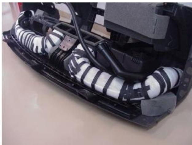
Figura 6.1 Dutos isolados por uma manta térmica.
