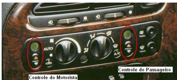
Figura 3.23 Painel de controle em um sistema com controles individuais de temperatura.
