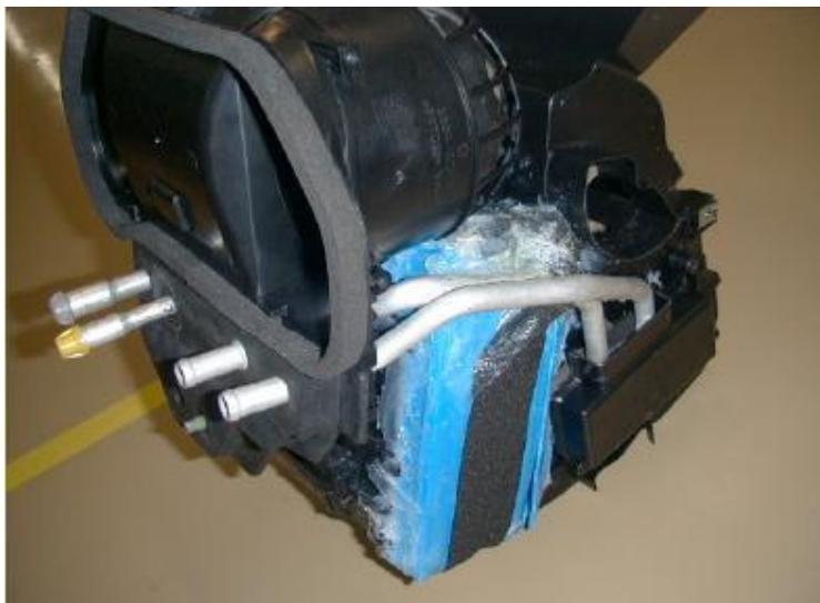
Figura 6.2 Melhoria na vedação da válvula que faz o isolamento entre o heater core e o evaporador.
