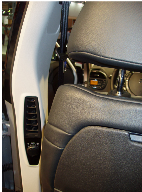
Figura 3.22 Veículo com difusor posicionado na coluna B.
