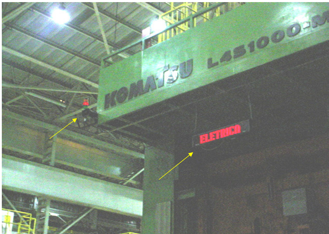
Figura 20 - Painel eletrônico e sirene do sistema andon na cabeceira da linha D.
