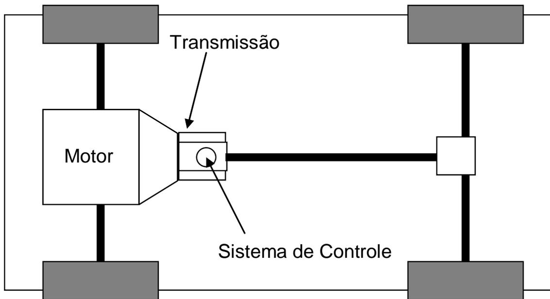
Figura 29 – Montagem longitudinal do conjunto motor e transmissão
