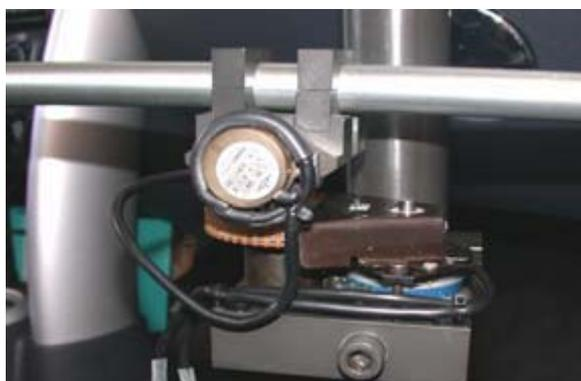
Figura 41 – Potenciômetro angular
