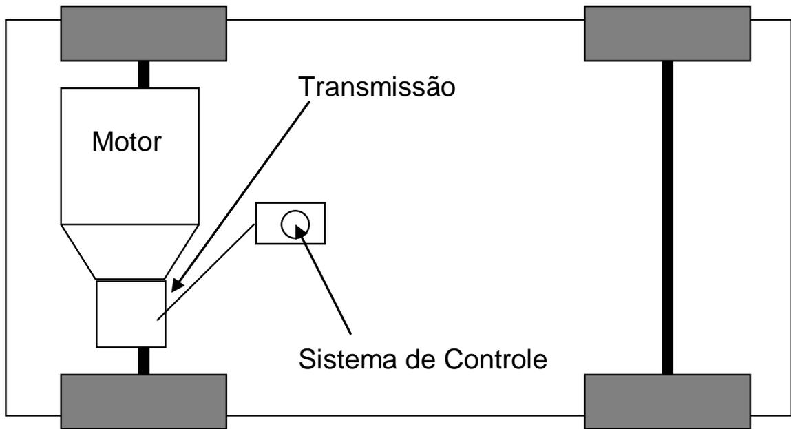
Figura 25 – Montagem transversal do conjunto motor e transmissão
