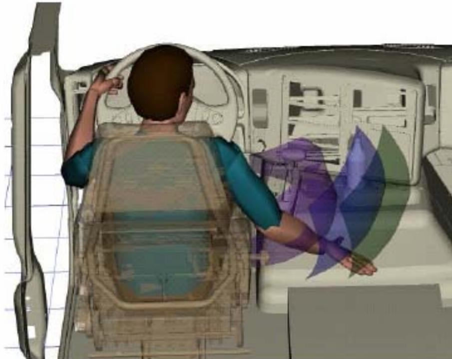
Figura 13 – Superfícies mostrando três níveis de acomodação (90%, 60% e 30%) para uma determinada força (Parkison e Reed, 2006).
