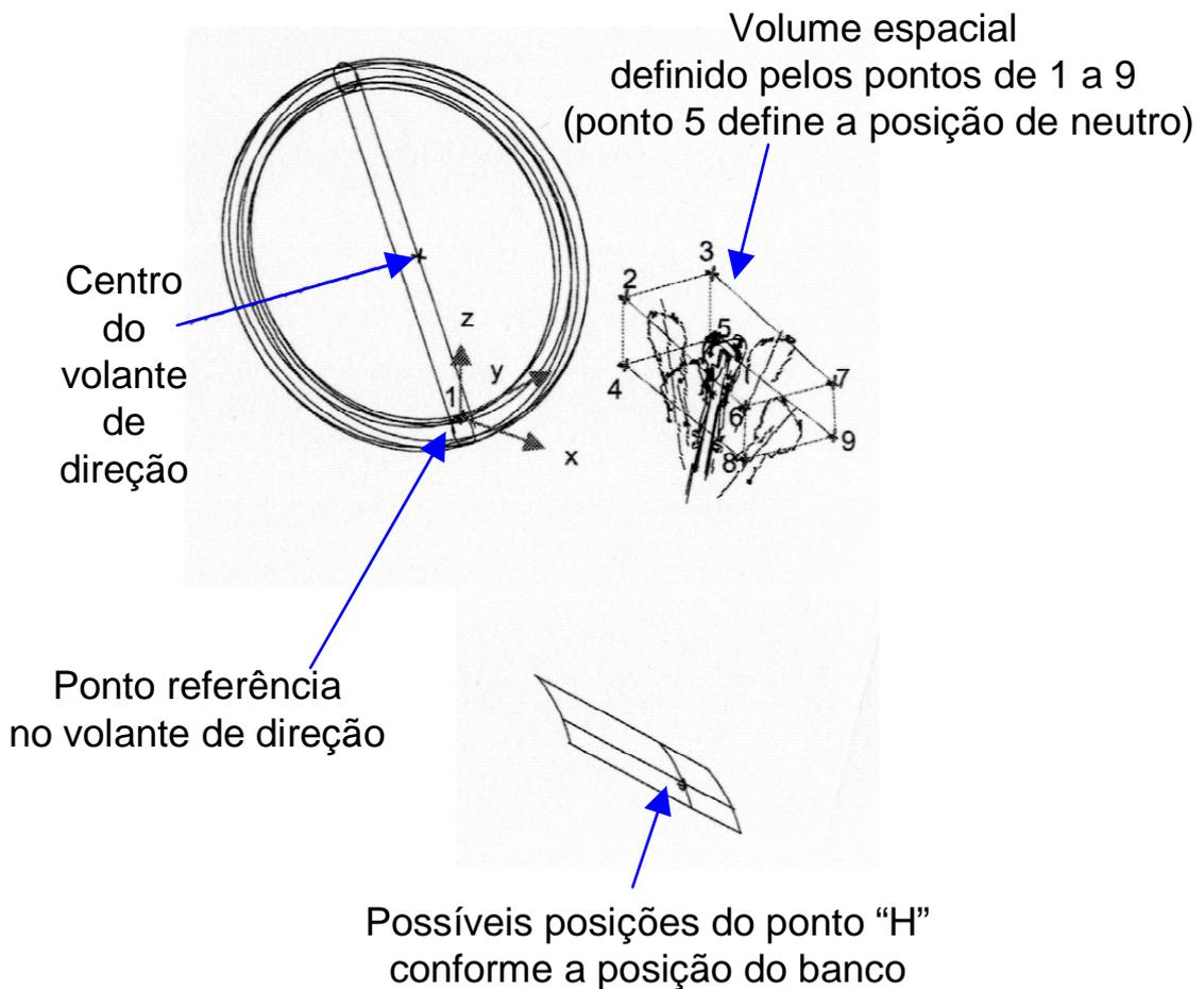
Figura 16 – Volume espacial de referência para posicionamento da alavanca
