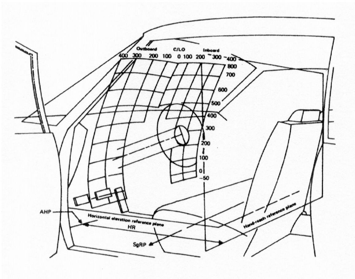
Figura 10 – Superfície de alcance gerada através da norma (SAE J287, 1998).
