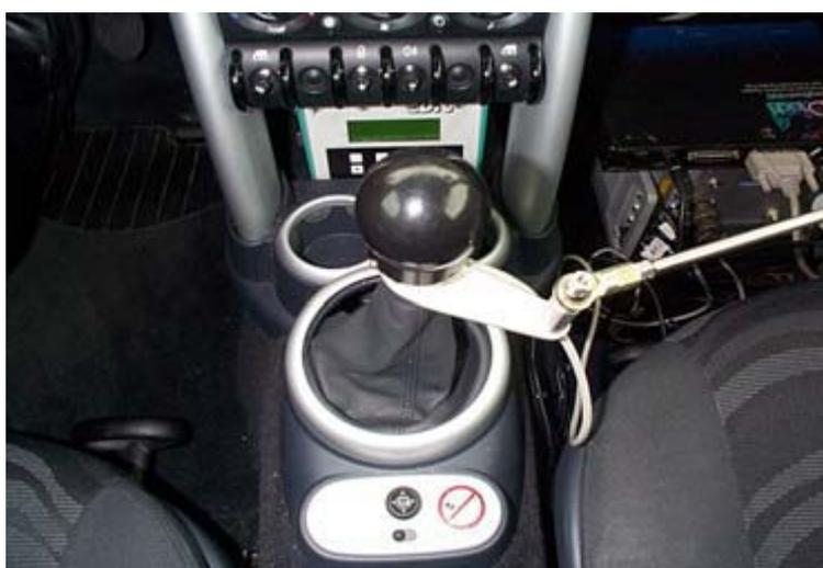
Figura 43 – Manopla instrumentada com células de carga
