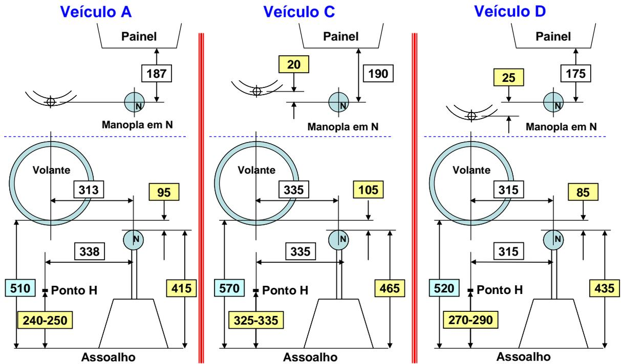
Figura 53 – Dimensões dos veículos analisados - continuação
