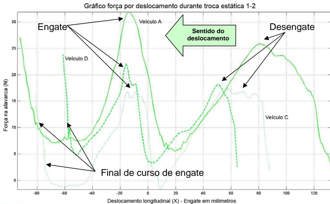
Figura 61 – Análise do gráfico de perfil de força no deslocamento durante troca estática (desengate seguido de engate)
