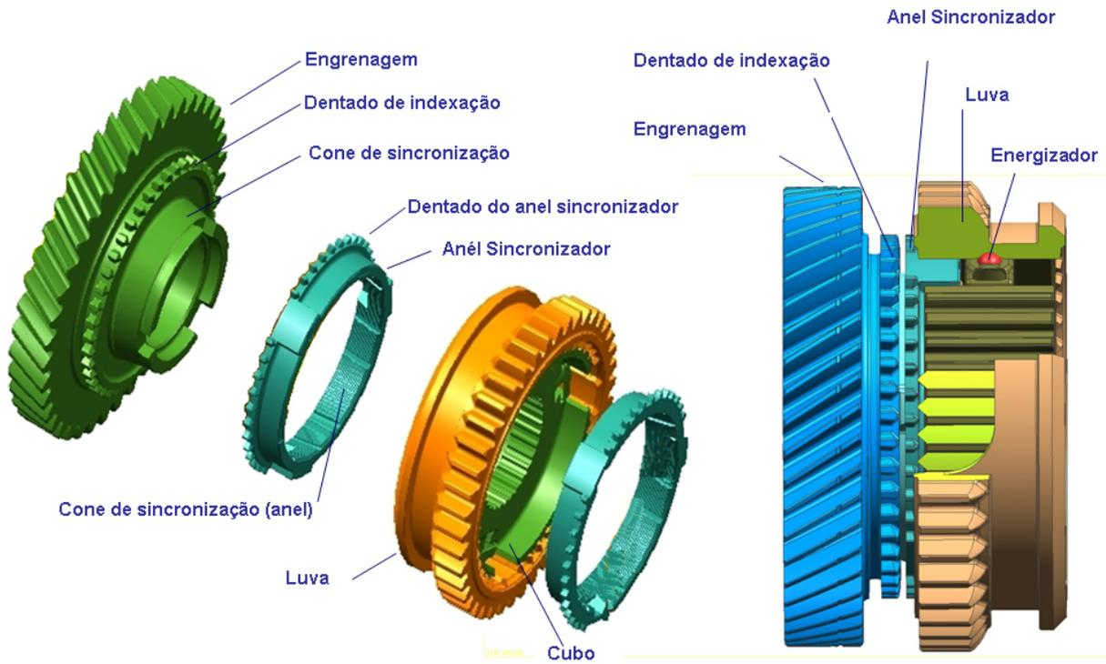
Figura 34 – Componentes do sistema de sincronização
