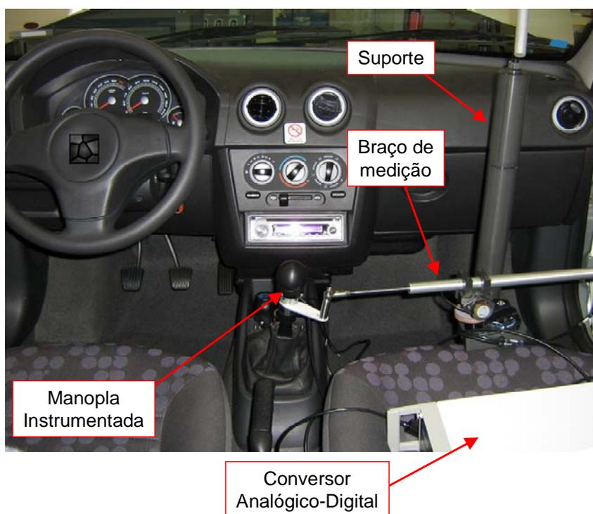
Figura 40 – Equipamento de aquisição instalado no veículo
