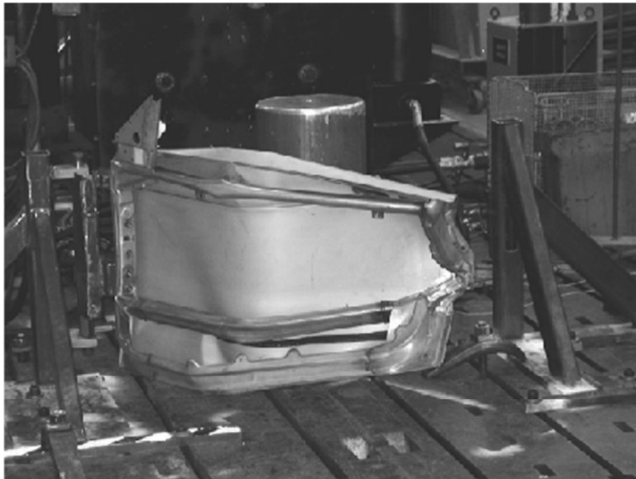
Figura 39. Porta do protótipo de demonstração após a intrusão lateral
