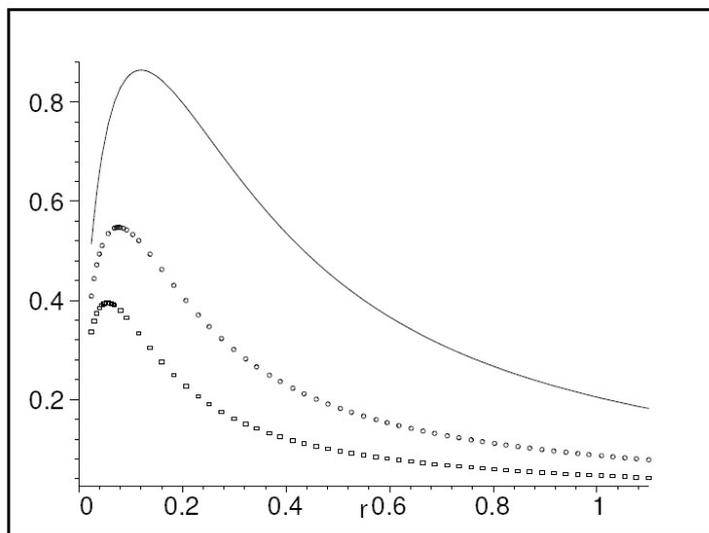
Figura 4: Gráficos para o potencial vetor em função de  $r$ , para o caso em que o vetor de fundo é puramente tipo-tempo. A linha pontilhada por quadrados corresponde ao caso MCS-Proca puro; A linha pontilhada por círculos com valor para o vetor de fundo  $v_0 = 14$ ; a linha contínua, corresponde a  $v_0 = 18$ . Os valores dos parâmetros são  $s = 20$  e  $M_A = 2$ .
