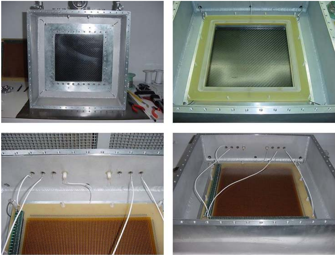
Figura 3-16: Fotos da montagem do detector proporcional de grande área (DPGA)
