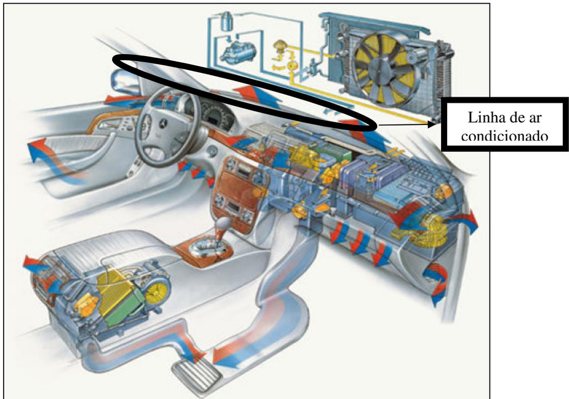
Figura 13- Sistema térmico veicular. Em destaque, circulado, a Linha de ar condicionado. Behr (2006)
