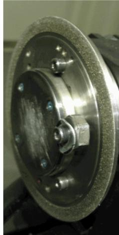
figura 4.17 - Detalhe da porca presa ao disco de dressagem.
