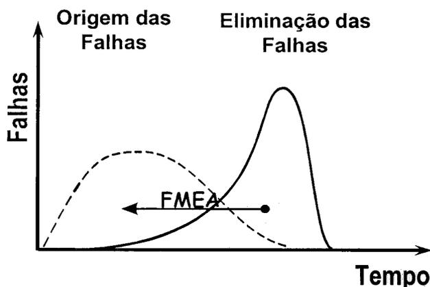
Fig. 4.1: Propósitos da aplicação do FMEA (Souza, 2004)
