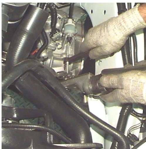
Fig. 7.6: Operador ajustando o cabo da embreagem
