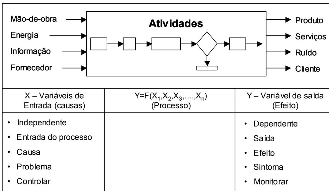
Fig. 2.5: Processo – perspectiva de modelagem (Rotondaro, 2002)
