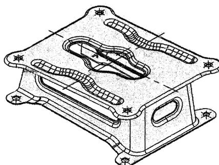
Fig. 7.11: Adaptador da alavanca de câmbio do Meriva
