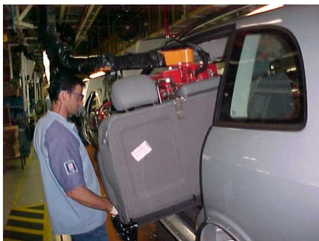
Fig. 7.19: Operador posicionando o banco traseiro dentro do veículo
