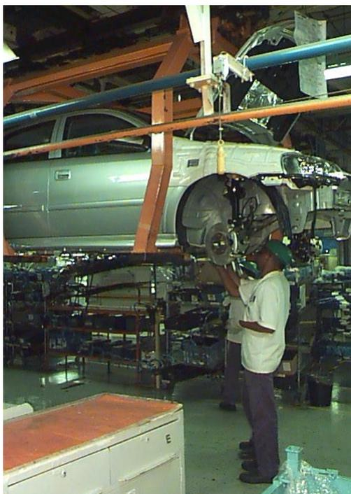
Fig. 9.3: Linha Aérea Mecânica
