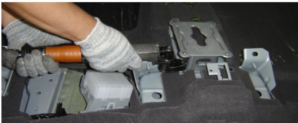
Fig. 7.13: Operador fixando o adaptador da alavanca de câmbio
