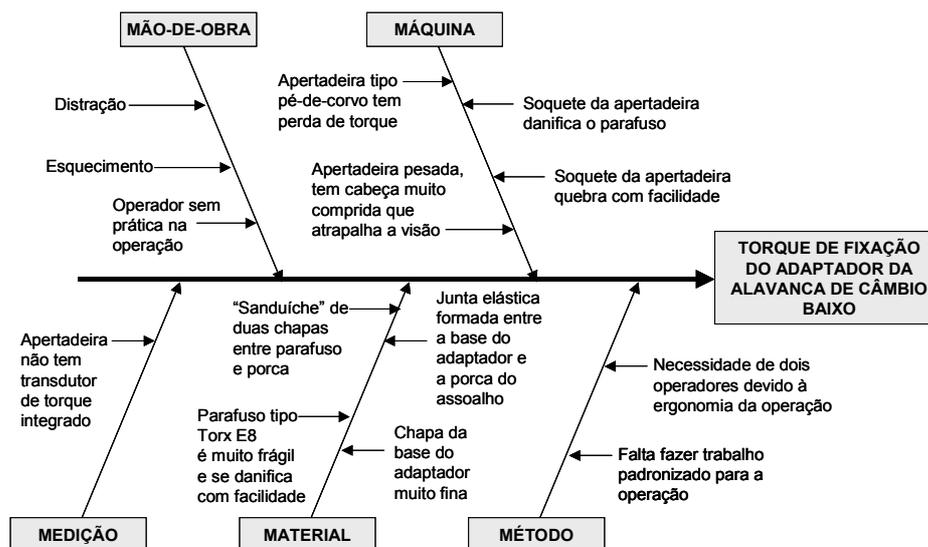
Fig. 7.14: Diagrama de Causa e Efeito aplicado ao problema “torque de fixação do adaptador da alavanca de câmbio baixo”
