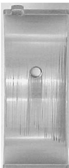
Figura 30: Foto típica de uma bronzina que não falhou no ensaio de fadiga
