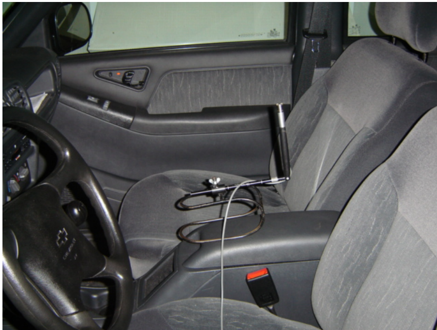
Figura 4.5: Posicionamento do microfone utilizado na medição da FRF entre monopolo e banco do motorista.
