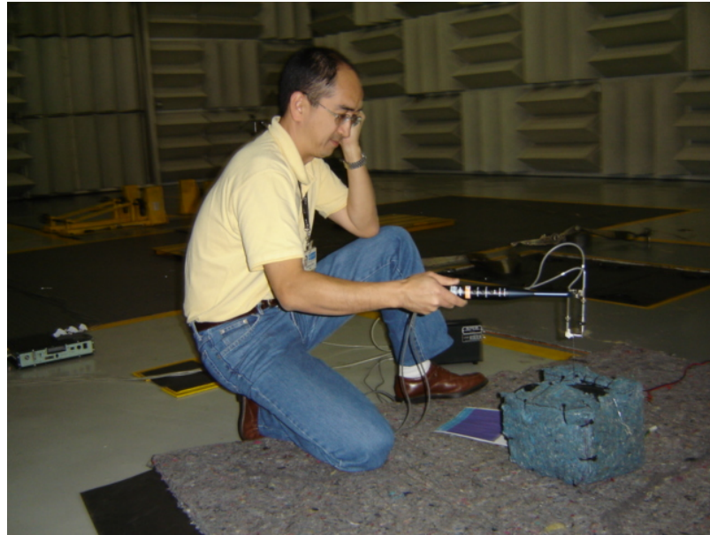
Figura 4.8: Medição de intensidade sonora da caixa acústica utilizada como sub-área irradiante dentro do cofre do veículo.
