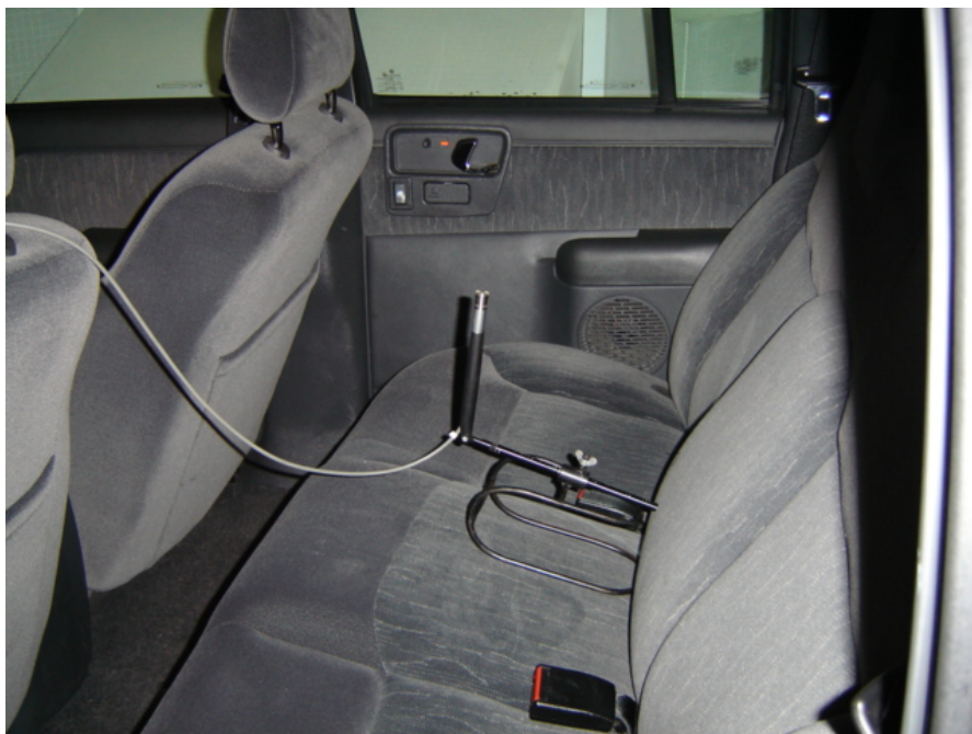
Figura 4.6: Posicionamento do microfone utilizado na medição da FRF entre monopolo e banco traseiro.
