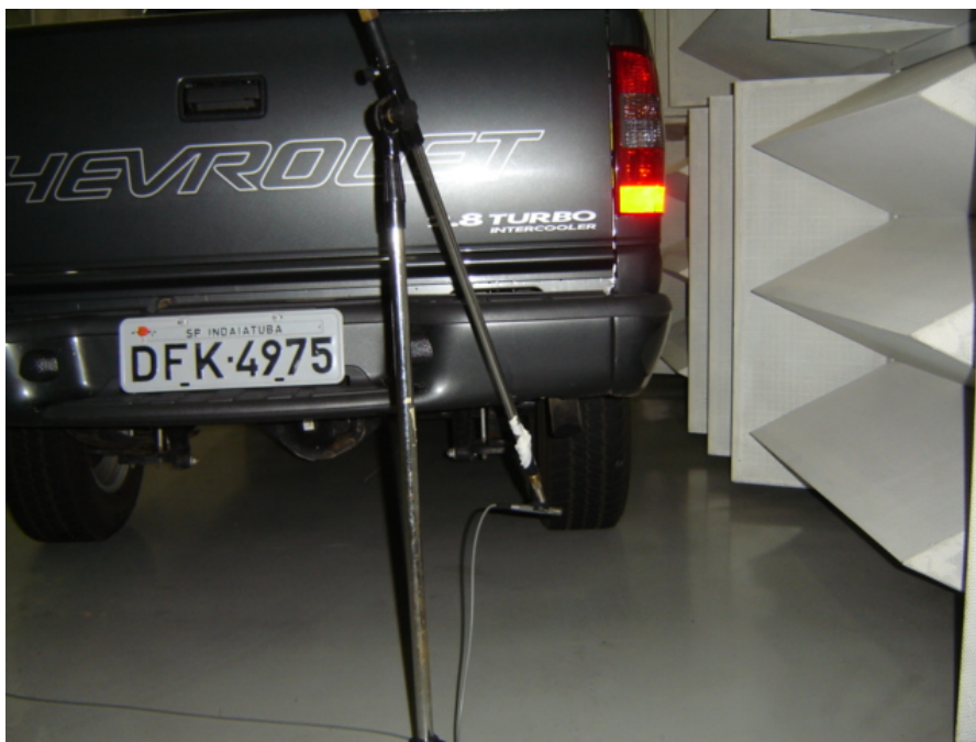
Figura 4.7: Posicionamento do microfone utilizado na medição da FRF entre monopolo e ponteira do escapamento.
