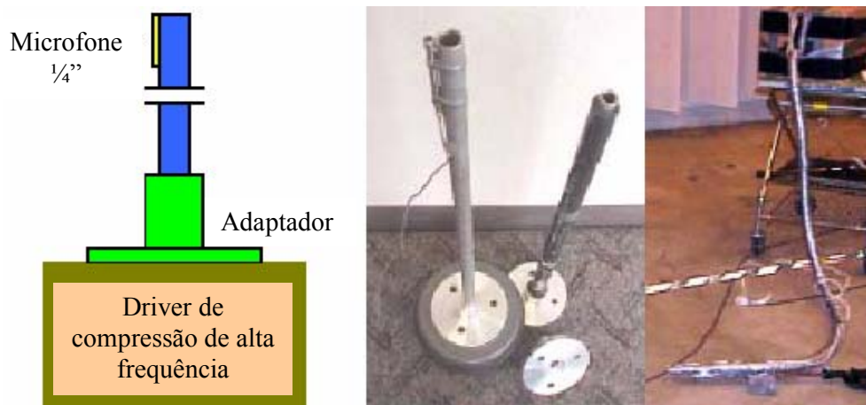
Figura 5.4: Monopolo construído a partir de um driver de compressão, que pode ser construído suficientemente pequeno a fim de que possa ser considerado como fonte pontual em médias e altas frequências.
