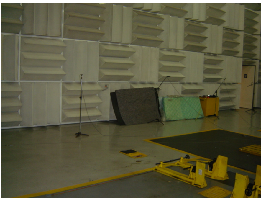
Figura 4.2: Disposição dos microfones que simularam as diferentes posições do veículo no teste de PBN.
