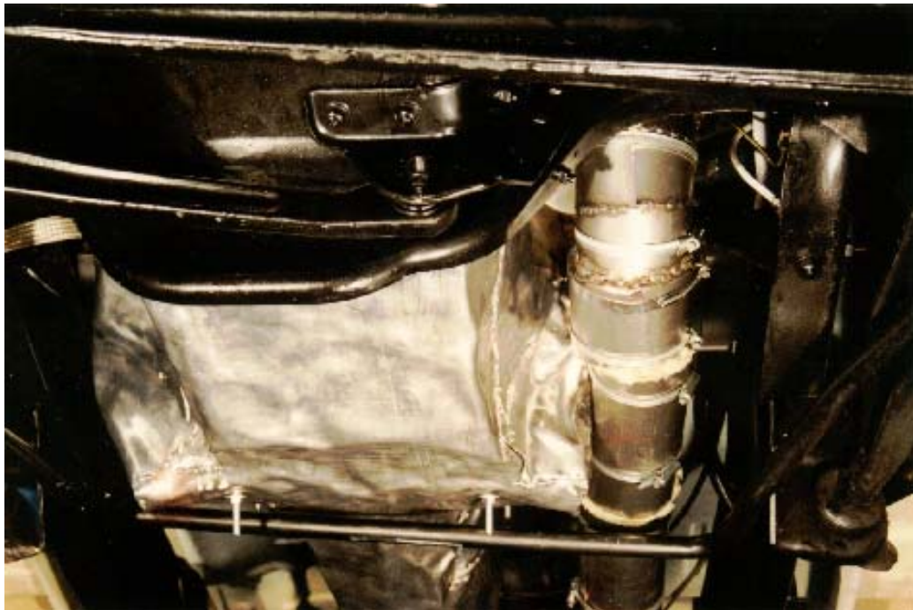
Figura 2.4: Encapsulamento do carter do motor e do tubo primário do escapamento.
