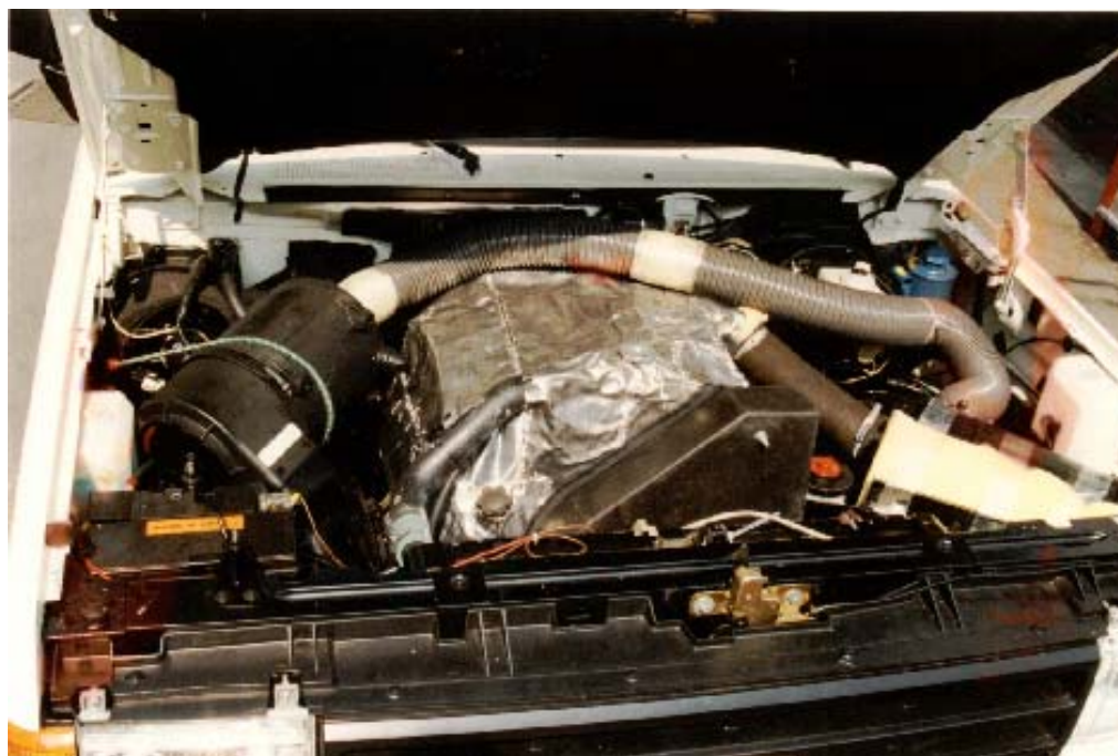
Figura 2.3: Encapsulamento do motor e adição de segundo filtro de ar.
