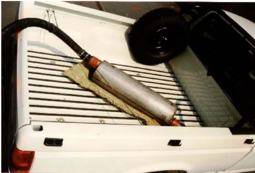
Figura 2.6: Adição de segundo silencioso instalado na caçamba para eliminar o ruído de ponteira de escapamento.
