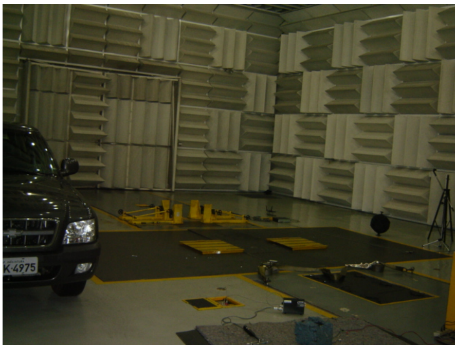
Figura 4.1: Posição do veículo testado na câmara semi-aneecóica.
