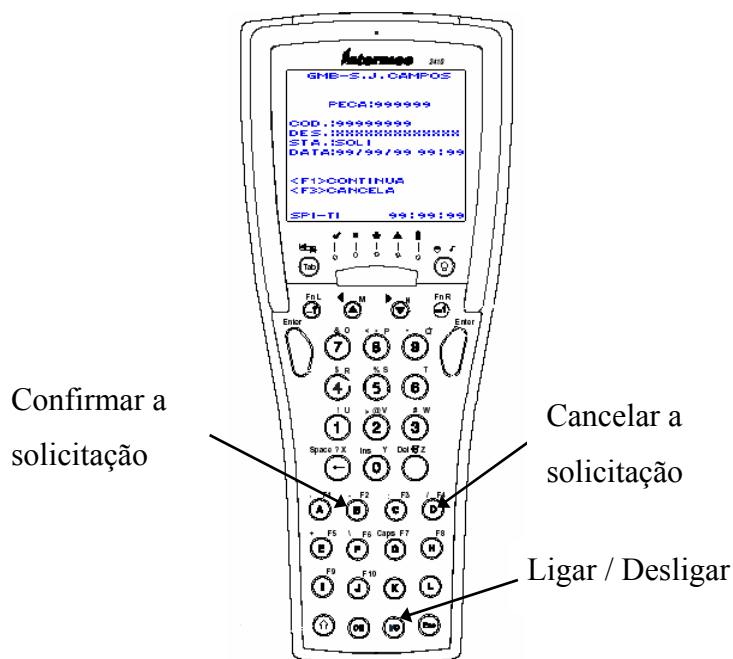
Figura 2.18 - Scanner : monitor com instruções para confirmar ou cancelar solicitação de itens componentes.
