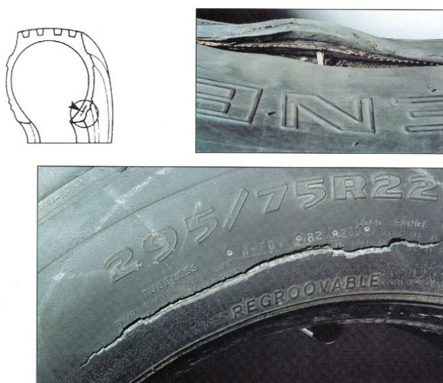
Figura 4.14 - Separação do reforço/chafer (TMC, 2004)
