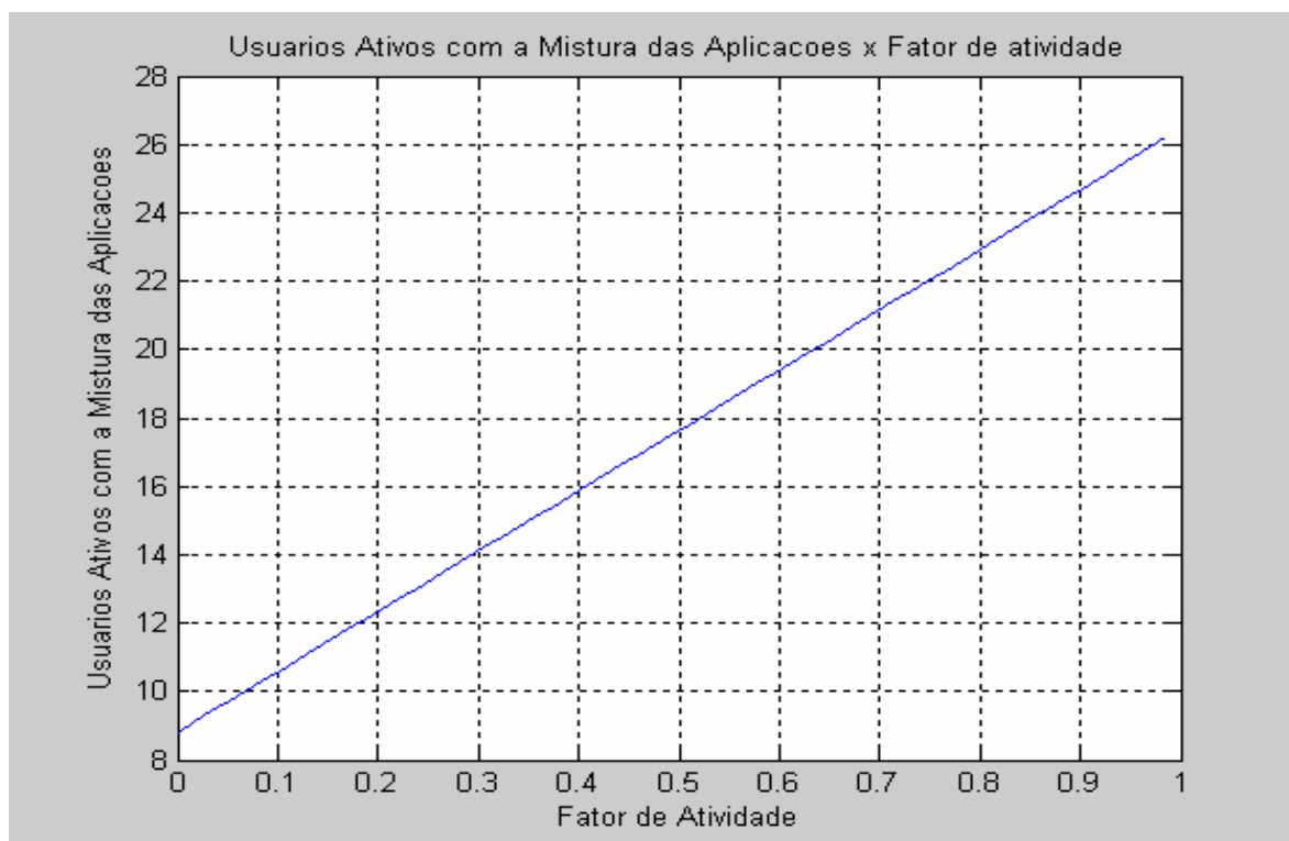
FIGURA 22 - . Distribuição número de usuários ativos com a mistura de aplicações em função do fator de atividade
