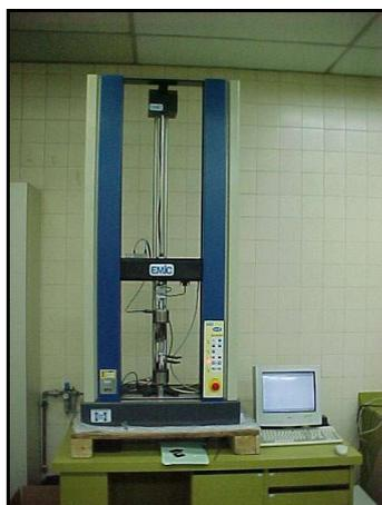
Figura 22 – Equipamento para ensaios de tração marca EMIC.
