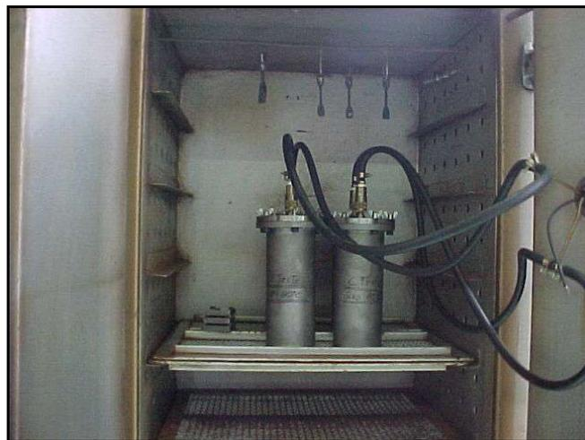
Figura 18 – Linhas de pressão e respiro no interior de uma estufa de teste.
