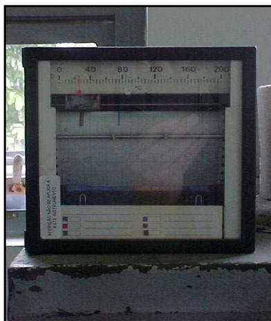
Figura 16 - Registrador de temperatura utilizado, marca Arucomp; escala de 0 a 350 °C; um canal por estufa.
