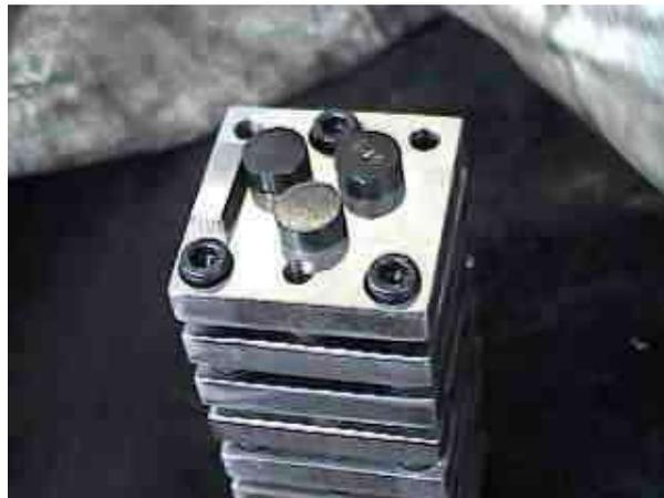
Figura 13 – Desmontagem do dispositivo para retirada dos corpos-de-prova.
