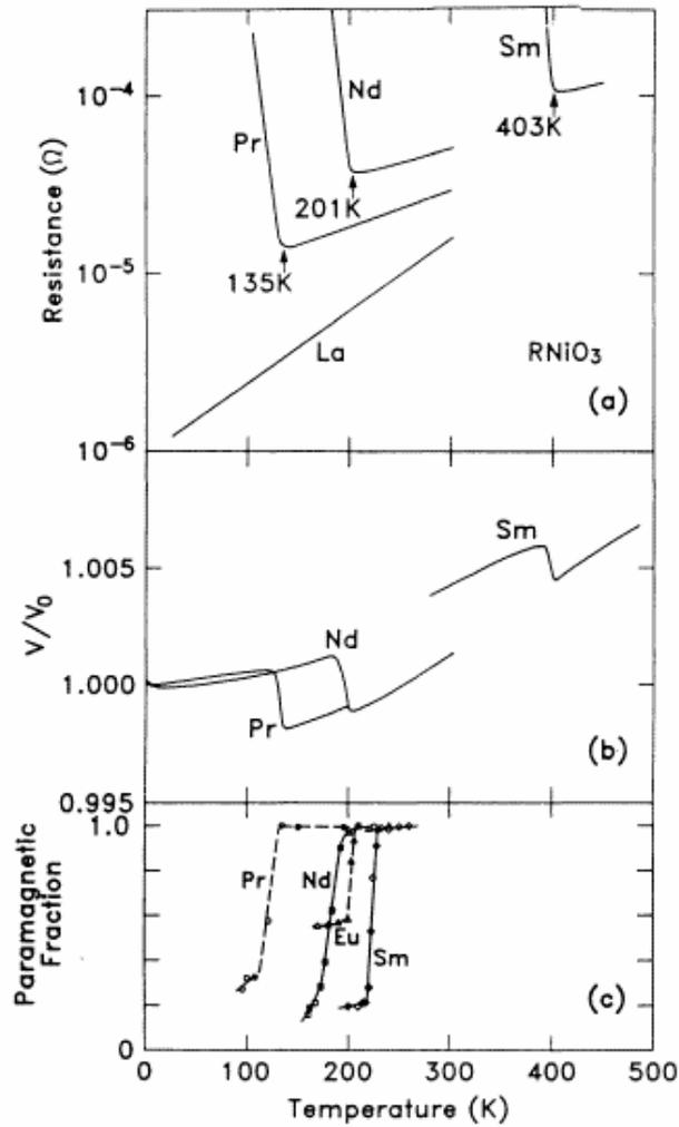
**Figure 2.6.** (a) Resistência elétrica do  $\text{LaNiO}_3$ ,  $\text{PrNiO}_3$ ,  $\text{NdNiO}_3$  e  $\text{SmNiO}_3$  mostrando suas transições metal-isolante. (b) Dependência com a temperatura do volume da cela unitária mostrando a anomalia a TMI. (c) A fração paramagnética determinada por experimentos de *muon spin rotation*, que cai repentinamente à temperatura de ordem antiferromagnético [3].
