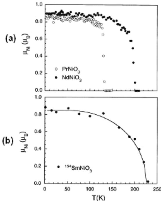
**Figura 2.14.** Evolução térmica dos momentos magnéticos do Ni para diferentes Niquelatos: (a)  $\text{PrNiO}_3$  ( $T_{MI} = 130\text{ K}$ ) [33] e  $\text{NdNiO}_3$  ( $T_{MI} = 200\text{ K}$ ) [17]; (b)  $\text{SmNiO}_3$  ( $T_{MI} = 400\text{ K}$ ) [46].
