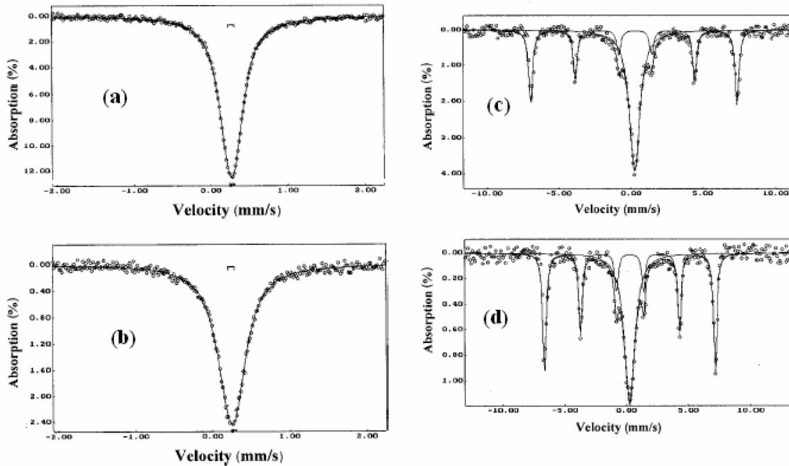
**Figura 2.23.** EM do (a)  $\text{NdNi}_{0,98}\text{Fe}_{0,02}\text{O}_3$  e (b)  $\text{SmNi}_{0,98}\text{Fe}_{0,02}\text{O}_3$  para temperatura ambiente, e (c)  $\text{NdNi}_{0,98}\text{Fe}_{0,02}\text{O}_3$  e (d)  $\text{SmNi}_{0,98}\text{Fe}_{0,02}\text{O}_3$  para 60K [57].
