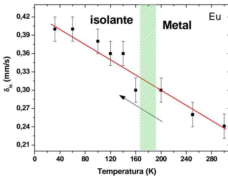
Figura 5.4. Deslocamento isomérico do  $^{57}\text{Fe}$  em função da temperatura para o  $\text{EuNi}_{0,99}\text{Fe}_{0,01}\text{O}_3$ , a linha contínua representa um ajuste linear descrito no texto.
