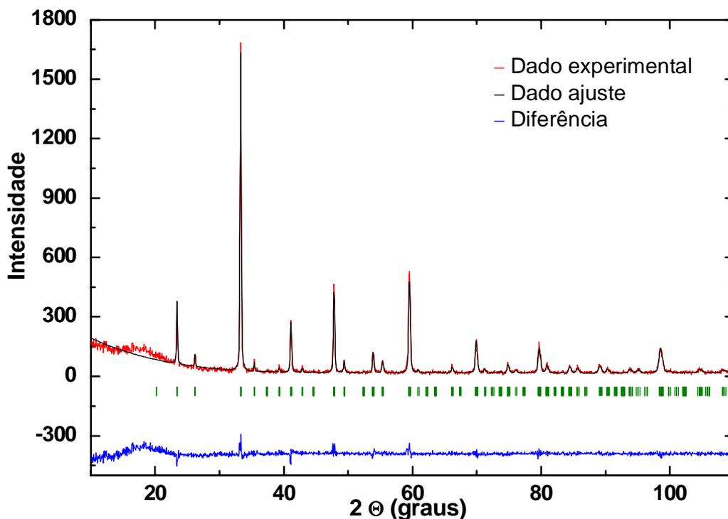
Figura 4.3. Padrão de difração de raios-x do  $\text{NdNi}_{0,99}\text{Fe}_{0,01}\text{O}_3$  à temperatura ambiente. As linhas em vermelho representam os dados experimentais, enquanto a linha contínua em preto corresponde ao ajuste realizado pelo método de Rietveld. Ainda, a linha contínua em azul representa a diferença entre os dados experimentais e calculados.
