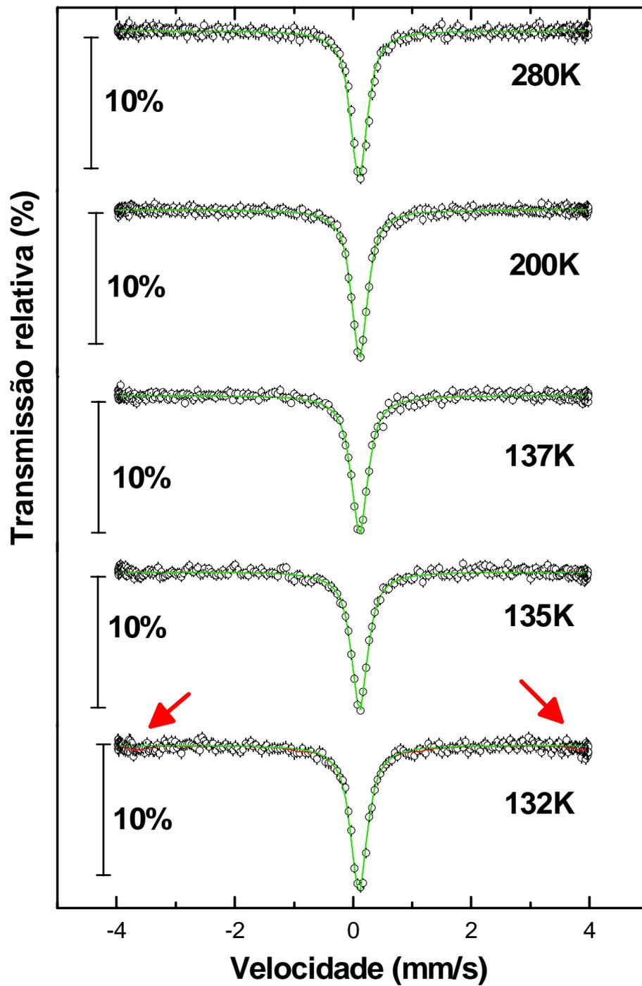
**Figura 4.5.** Espectros Mössbauer correspondentes ao  $\text{NdNi}_{0.99}\text{Fe}_{0.01}\text{O}_3$  para  $T > T_N$ . Observa-se uma pequena inclinação nos extremos da linha base do espectro de 135K (seta vermelha).
