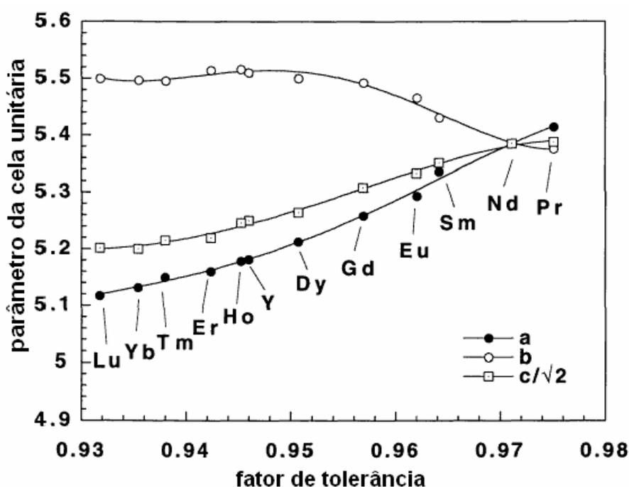
**Figura 2.4.** A variação dos parâmetros de rede em função do fator de tolerância para a série  $\text{NiO}_3$ . O valor de  $t$  tem sido calculado, usando,  $d_{\text{Ni-O}}=1,94$  e os valores e das distâncias R-O foram tomados de [8].
