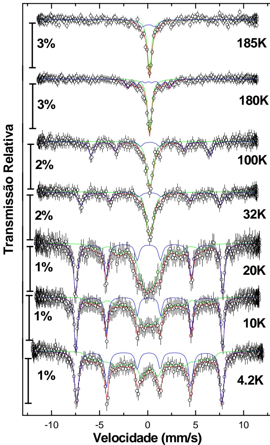
**Fig 4.18.** Espectros Mössbauer do  $\text{EuNi}_{0.99}\text{Fe}_{0.01}\text{O}_3$  para  $T < T_N$ . A linha azul corresponde ao sítio Fe(II), a linha verde corresponde ao sítio Fe(I), e a linha vermelha o ajuste do espectro.
