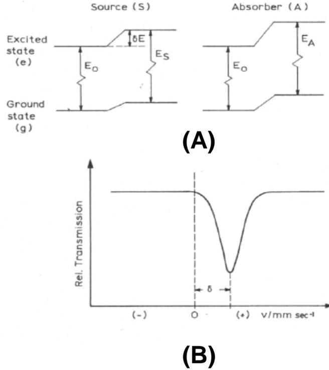
Fig A.4 (A) deslocamento quadrupolar do  $^{57}\text{Fe}$  com  $i=3/2$  no excitado e  $I=1/2$  no estado fundamental; (B) espectro resultante.
