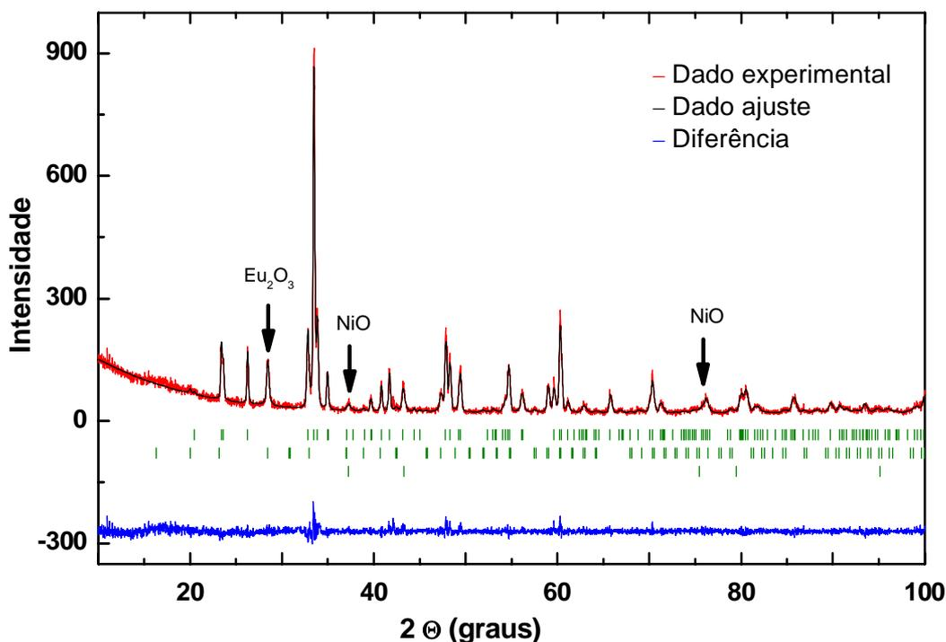
**Fig 4.4.** Padrão de difração de raios-x do  $\text{EuNi}_{0.99}\text{Fe}_{0.01}\text{O}_3$  à temperatura ambiente, enquanto a linha contínua em preto corresponde ao ajuste realizado pelo método de Rietveld. Ainda, a linha contínua em azul representa a diferença entre os dados experimentais e calculados.
