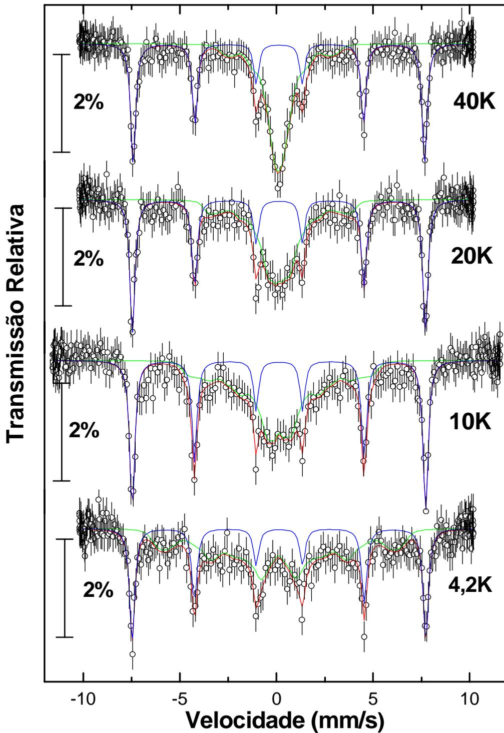
**Figura 4.8.** Espectros Mössbauer  $\text{NdNi}_{0.99}\text{Fe}_{0.01}\text{O}_3$  para  $4,2 \text{ K} < T < 40 \text{ K}$  durante o processo de resfriamento. O sexteto (linha azul) corresponde ao sítio magnético estático Fe(II). O sexteto alargado (linha verde) corresponde ao sítio magnético dinâmico Fe(I). O ajuste do espectro (linha vermelha) é a soma dos dois subspectros anteriores.
