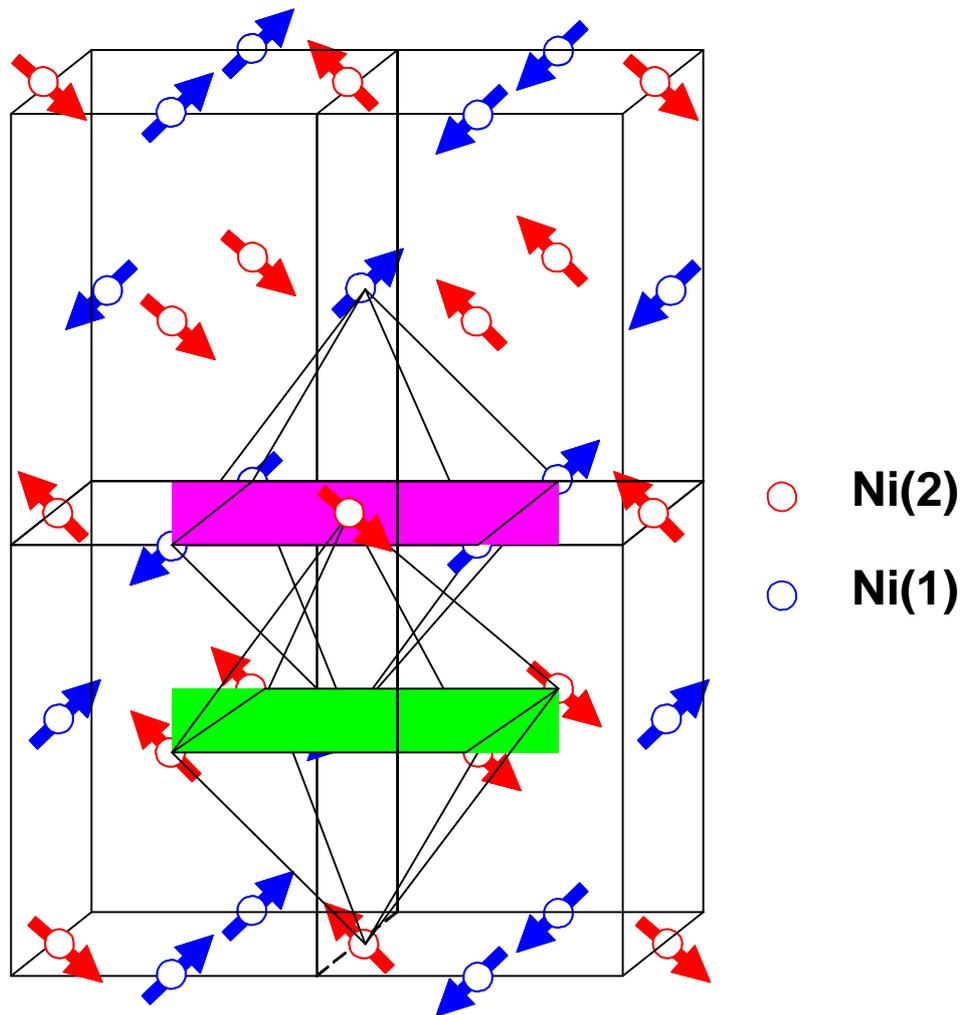
**Figura 5.2.** Estrutura magnética proposta para o  $\text{NdNi}_{0,99}\text{Fe}_{0,01}\text{O}_3$  [6]. Octaedros são desenhados em torno do  $\text{Ni}(1)$  e  $\text{Ni}(2)$  com seus 6 vizinhos mais próximos.
