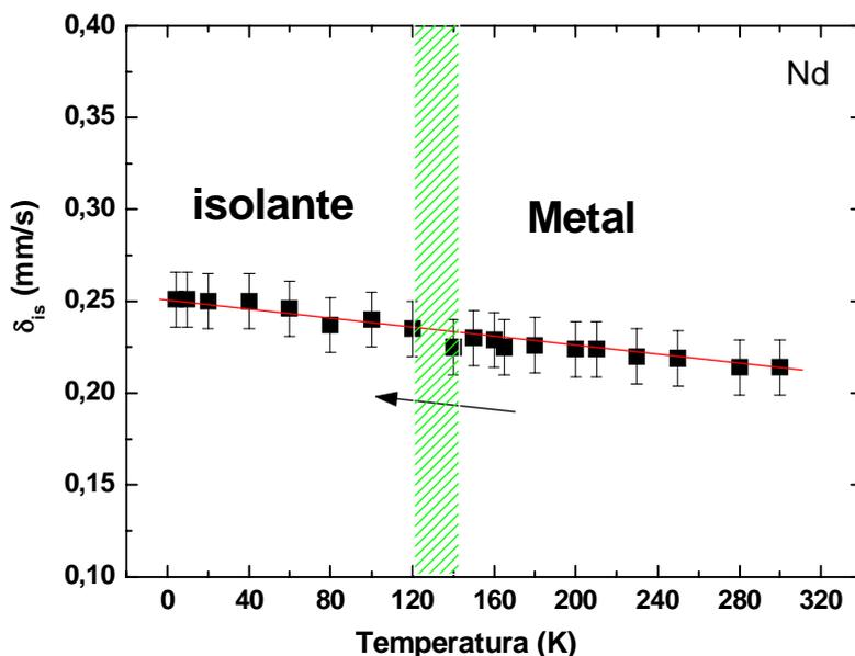
**Figura 5.5.** Deslocamento isomérico do  $^{57}\text{Fe}$  em função da temperatura para o  $\text{NdNi}_{0,99}\text{Fe}_{0,01}\text{O}_3$ , a linha contínua representa um ajuste linear descrito no texto.
