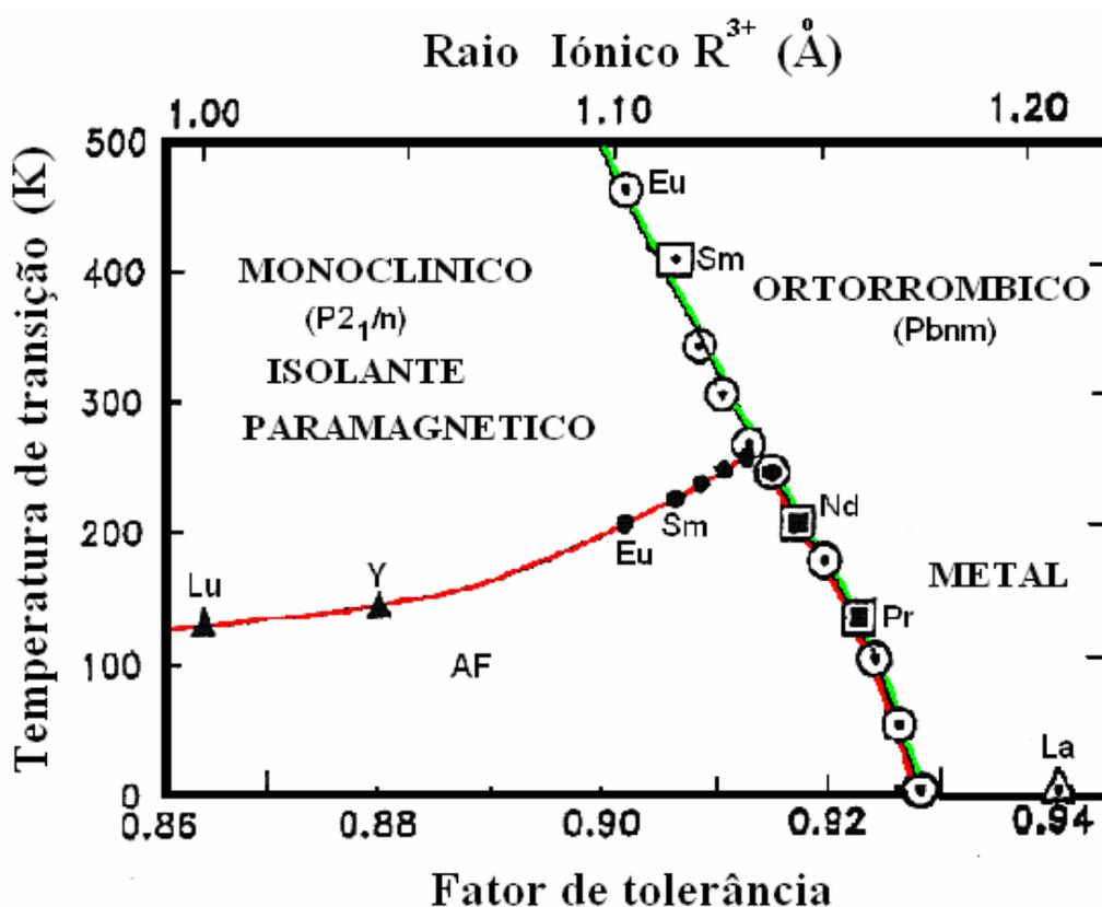
Figura 2.7. Diagrama de fase da série de RNiO<sub>3</sub> [22,29]. Temperatura de transição em função do raio iônico R<sup>3+</sup> e o fator de tolerância *t*. A linha verde é a separação do estado metal para o isolante. A linha vermelha indica a transição magnética.
