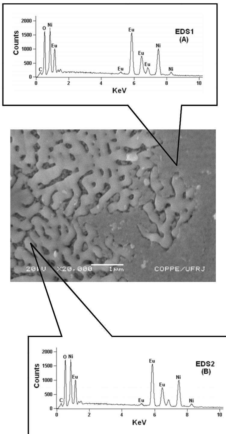
**Figura 4.1.** Micrografia obtida com o microscópio eletrônico de varredura para o composto  $\text{EuNi}_{0.99}\text{Fe}_{0.01}\text{O}_3$ . Também são mostrados espectros EDS em duas regiões diferentes da amostra.
