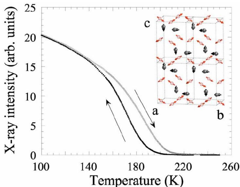
**Figura 2.17.** Dependência com a temperatura da reflexão  $(1/2\ 0\ 1/2)$  para o  $\text{NdNiO}_3$  esfriando e aquecendo o sistema. Figura interna: Estrutura magnética proposta para o  $\text{NdNiO}_3$  [54]. Os círculos abertos representam os íons de Ni com seus momentos dipolares magnéticos e os círculos fechados representam os íons de Nd com seus preditos momentos induzidos.
