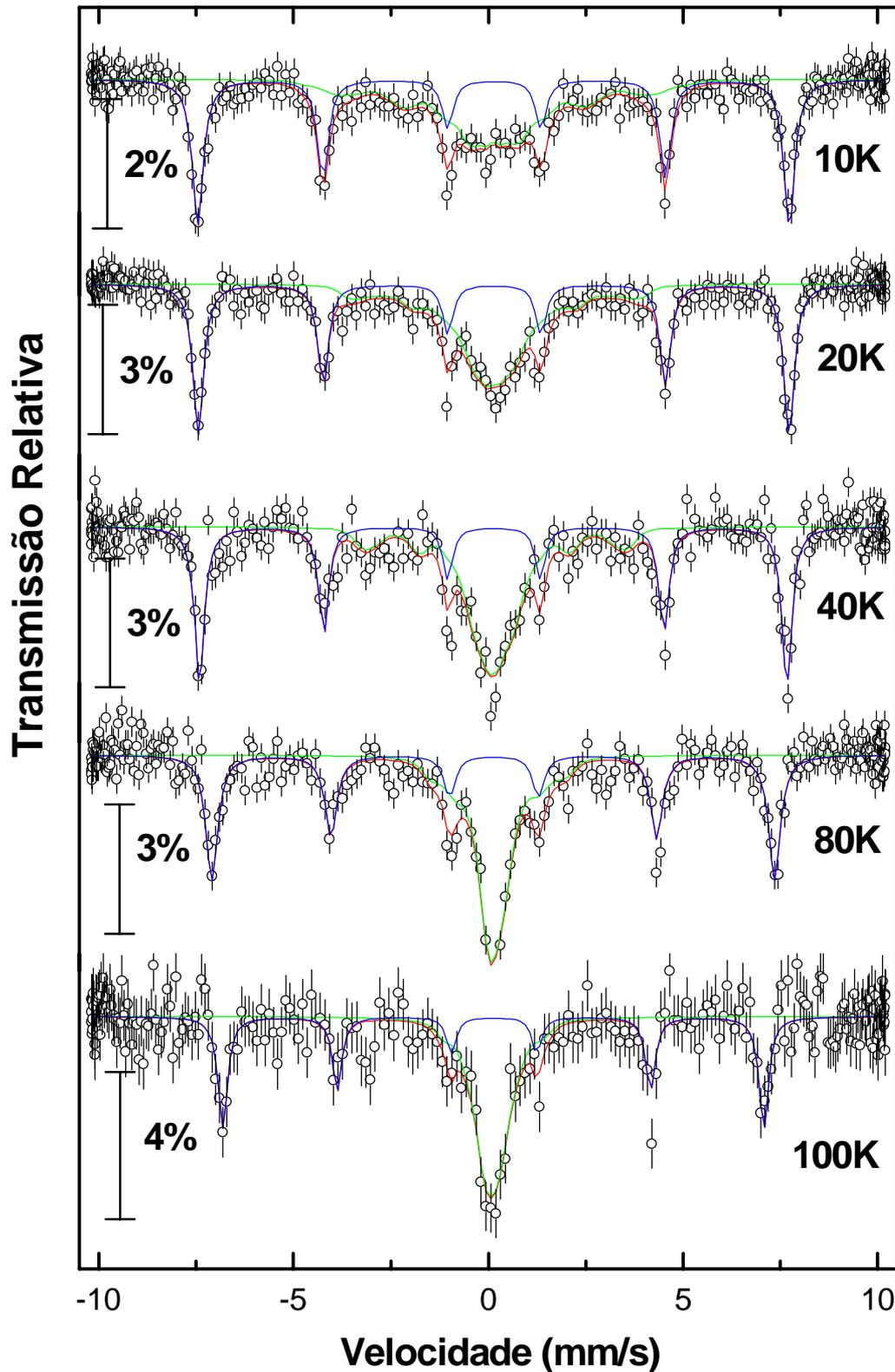
**Figura 4.11.** Espectros Mössbauer do  $\text{NdNi}_{0.99}\text{Fe}_{0.01}\text{O}_3$  para  $10\text{K} < T < 100\text{K}$ , durante o processo de aquecimento. A linha azul corresponde ao sítio Fe(II), a linha verde corresponde ao sítio Fe(I), e a linha vermelha o ajuste do espectro.
