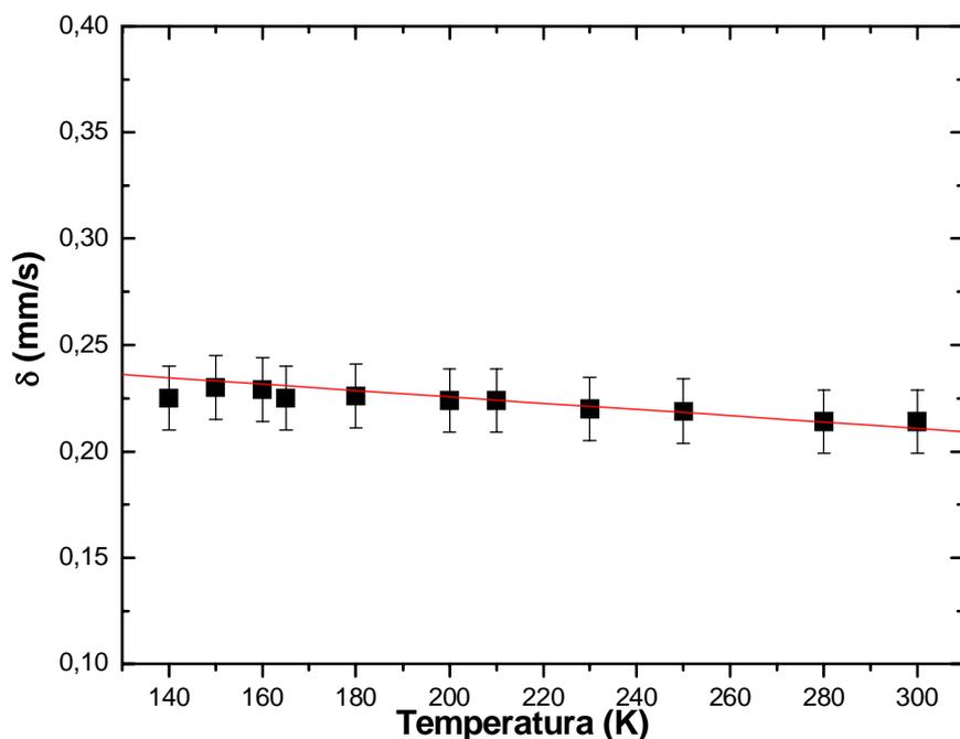
**Figura 4.6.** Deslocamento isomérico do  $^{57}\text{Fe}$  em função da temperatura para o  $\text{NdNi}_{0,99}\text{Fe}_{0,01}\text{O}_3$ , a linha contínua representa um ajuste linear descrito no texto.
