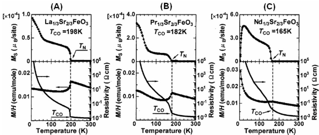
**Fig C.3** Magnetização espontânea ( $M_s$ ), resistividade elétrica ( $\rho$ ) susceptibilidade magnética ( $\chi$ ) para o  $\text{R}_{1/3}\text{Sr}_{2/3}\text{FeO}_3$  em função da temperatura [15] (A)La, (B)Pr (C) Nd.
