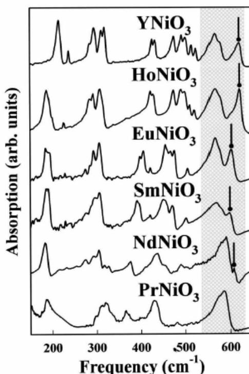
**Figura 2.11.** Espectro de absorção de rede para diferentes RNiO<sub>3</sub> a 77 K [33]. A seta a  $\sim 600\text{ cm}^{-1}$  indica o desdobramento da banda de fônon o qual está relacionado a uma estrutura monoclinica. A desproporção de carga correlaciona com a distorção monoclinica no RNiO<sub>3</sub> com íons de terras raras grandes.
