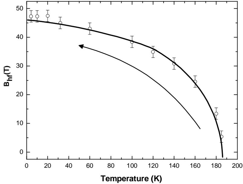
**Figura 4.19.**  $B_{hf}$  em função da temperatura para o sítio Fe(II) do  $\text{EuNi}_{0,99}\text{Fe}_{0,01}\text{O}_3$ .
