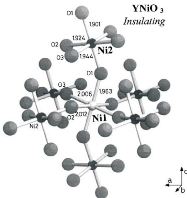
**Figura 2.10.** Coordenação de oxigênio para os Ni(I) e Ni(II) no  $\text{YNiO}_3$  (fase isolante) medida por difração de nêutron [16]. Cada  $\text{Ni(I)O}_6$  comparte a esquina com outros 6 octaedros  $\text{Ni(II)O}_6$  e vice-versa.
