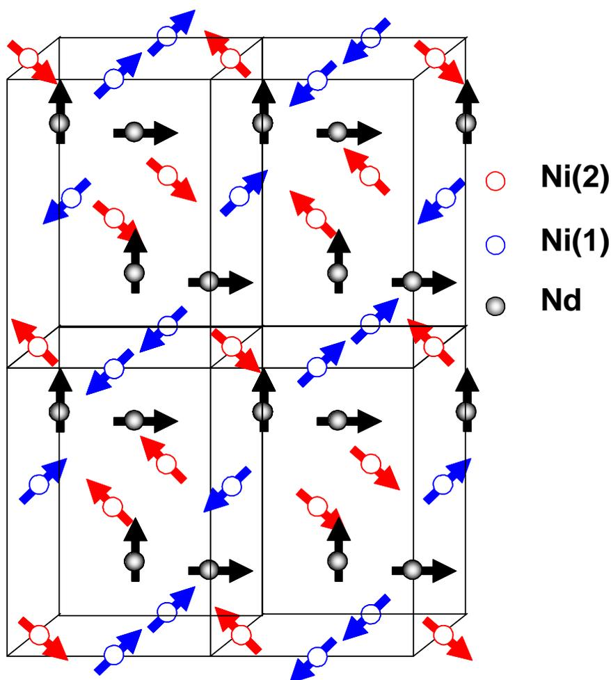
**Figura 5.1.** Estrutura magnética proposta para o  $\text{NdNi}_{0,99}\text{Fe}_{0,01}\text{O}_3$  [ 6].
