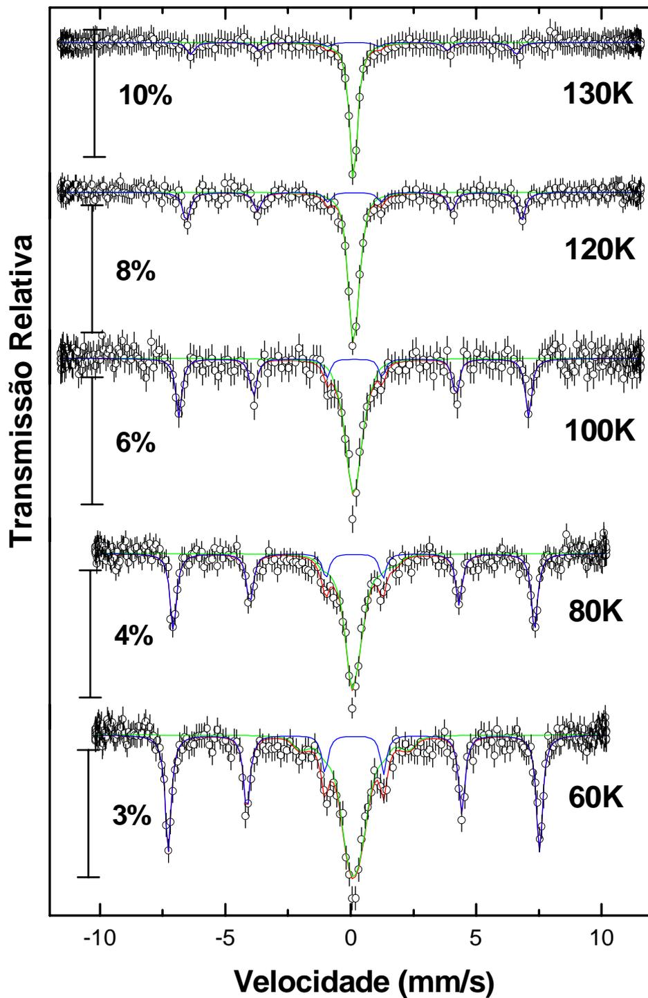
**Figura 4.7.** Espectros Mössbauer  $\text{NdNi}_{0.99}\text{Fe}_{0.01}\text{O}_3$  para  $60 \text{ K} < T < 130$  durante o processo de resfriamento. O sexteto (linha azul) corresponde ao sítio magnético estático Fe(II). O singlete alargado (linha verde) corresponde ao sítio magnético dinâmico Fe(I). O ajuste do espectro (linha vermelha) é a soma dos dois subspectros anteriores.
