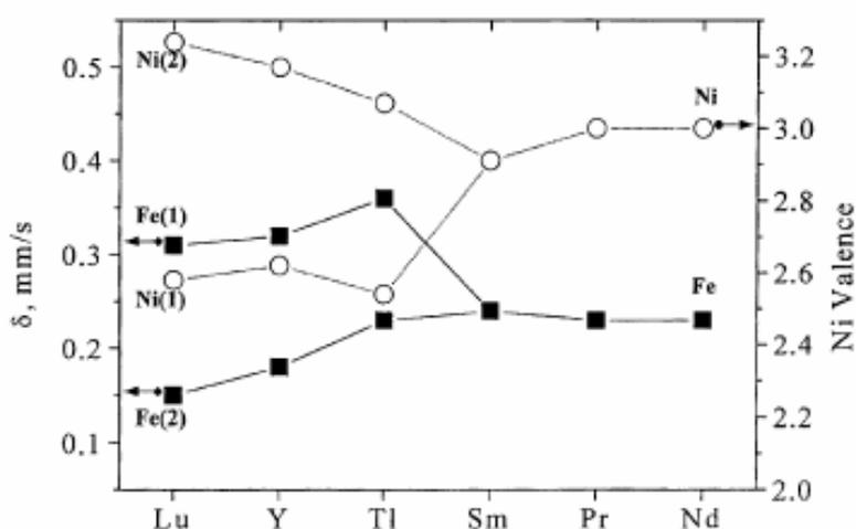
**Figura 2.22.** Variação do deslocamento isomérico dos sítios de Fe(1) e Fe(2) nas posições Ni(1) e Ni(2), em função de R no  $\text{RNi}_{0,98}\text{Fe}_{0,02}\text{O}_3$ , [56,55].
