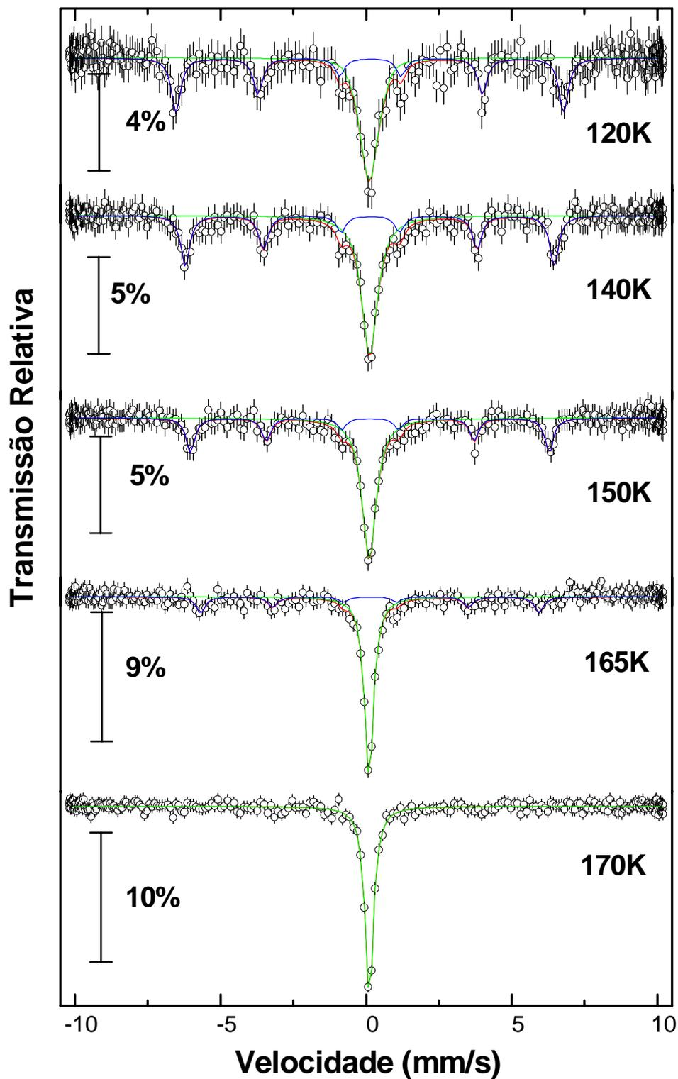
**Figura 4.12.** Espectros Mössbauer do  $\text{NdNi}_{0.99}\text{Fe}_{0.01}\text{O}_3$  para  $120 \text{ K} < T < 170 \text{ K}$ , durante o processo de aquecimento. A linha azul corresponde ao sítio Fe(II), a linha verde corresponde ao sítio Fe(I), e a linha vermelha o ajuste do espectro.
