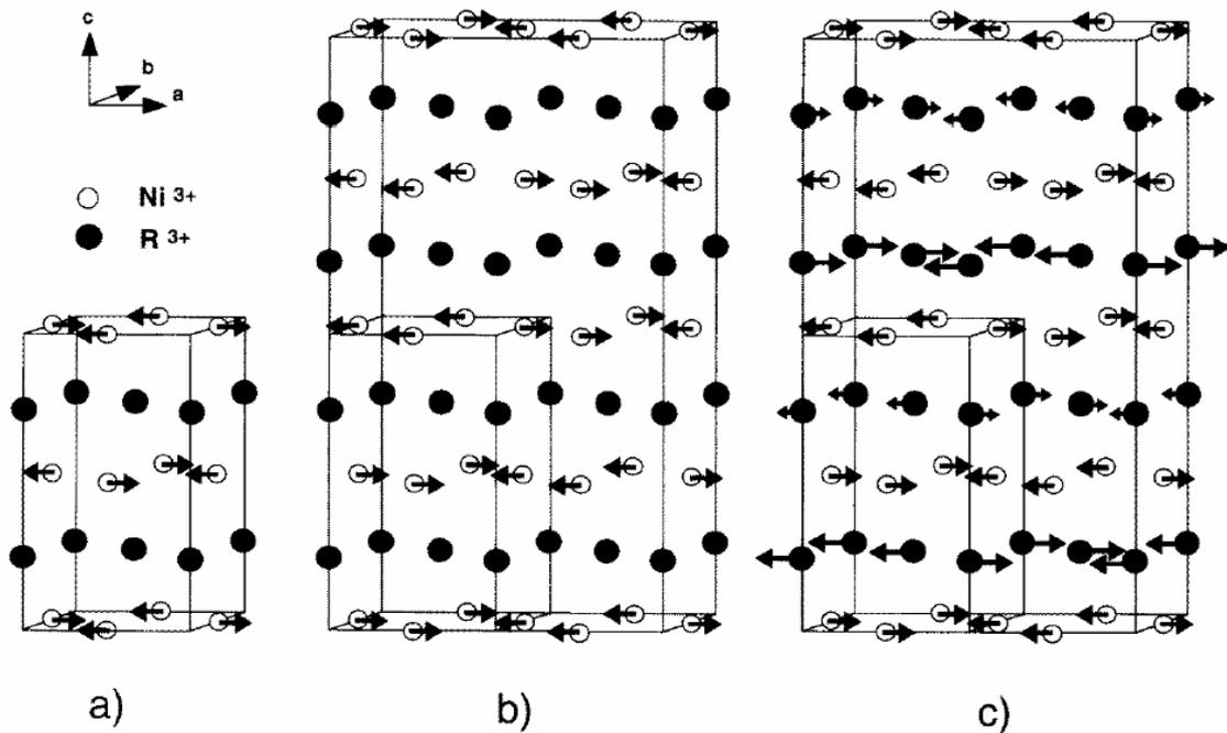
**Figura 2.13.** Estrutura magnética do PrNiO<sub>3</sub>: (a) predito por Demazeau e autores [47] (A direção absoluta dos momentos magnéticos dos átomos de Ni tem sido escolhida arbitrariamente nesta figura); (b) como encontrado experimentalmente [17]. (c) A estrutura magnética do NdNiO<sub>3</sub> [10] e SmNiO<sub>3</sub> [46] abaixo de 30 K.
