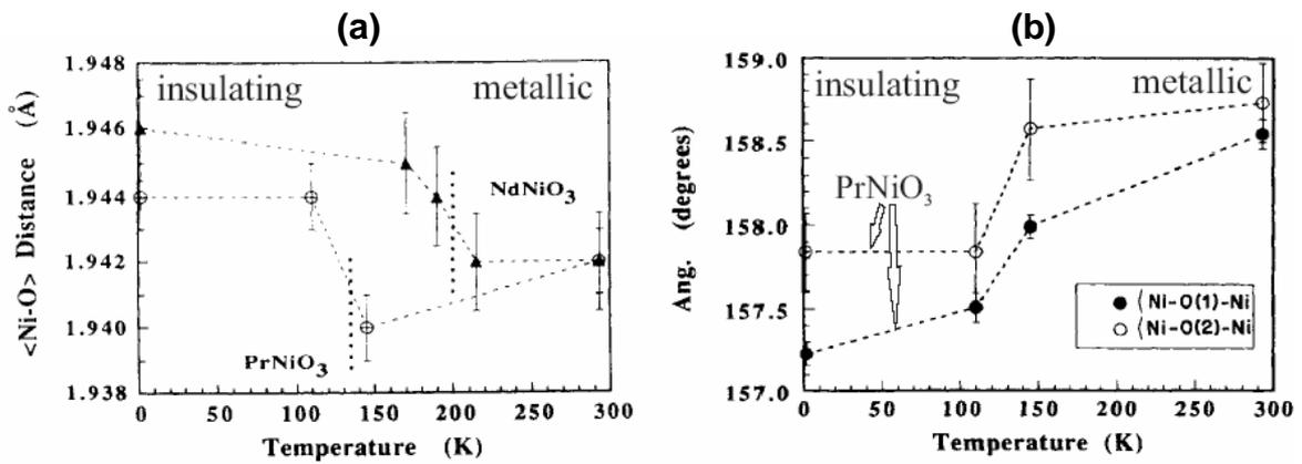
**Figura 2.8.** (a) Variação da longitude de ligação  $d_{\text{Ni-O}}$ , que apresenta as anomalias da estrutura na transição MI para o PrNiO<sub>3</sub> e o NdNiO<sub>3</sub>, (b) salto do ângulo de ligação Ni-O-Ni a  $T_{MI}$  no PrNiO<sub>3</sub> que governa a transferência inteira entre os orbitais Ni 3d e O 2p [9].
