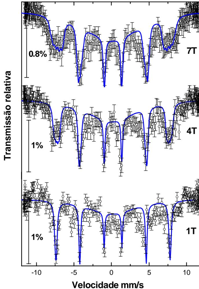
**Figura 4.24.** Espectros Mossbauer com diferentes campos magnéticos externos  $B_{ext}$  para o  $\text{EuNi}_{0.99}\text{Fe}_{0.01}\text{O}_3$  a 4.2 K
