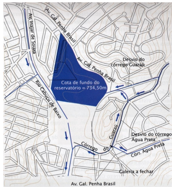
Figura 57b – Desvios executados na Bacia do Córrego Guaraú. Canholi, 2005.
