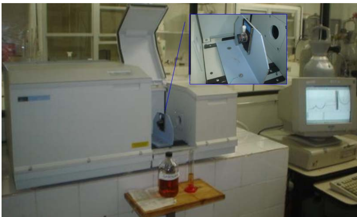
Figura 2.1. Espectrômetro FT-IR equipado com uma cela de quartzo de caminho óptico de 1.0 cm e gerenciado por um computador Pentium .
