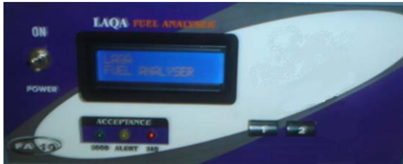
Figura 2.13. Detalhes do painel externo de controle e operação do FMNIR.
