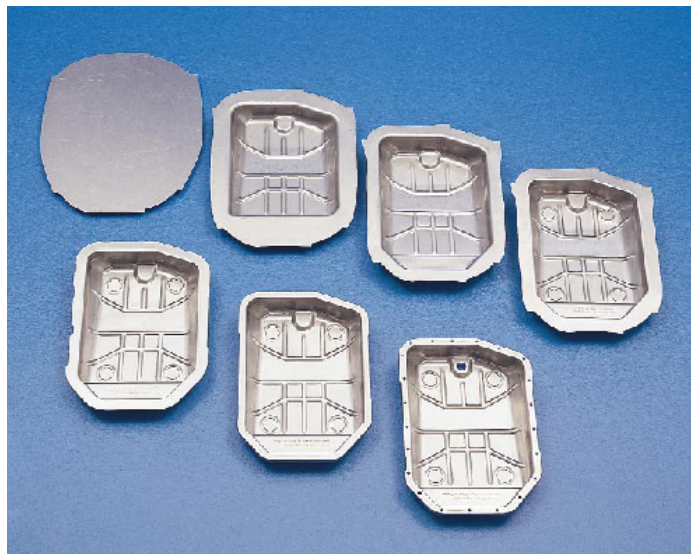
Figura 3.6.1 – Conformação do reservatório de óleo em cada operação (SCHULER, 1998).
