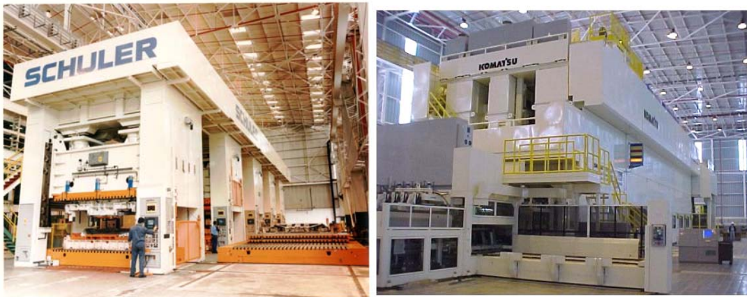
Figura 3.1.2 – Linhas de prensas mecânicas de alta capacidade de estampagem.
