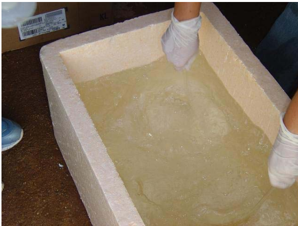
Figura 16 – Homogeneizando a água com bastões de vidro estéreis antes de encher as garrafas; Sitio Riacho da Serra, São José do Sabugi, PB; 16.12.2005.
