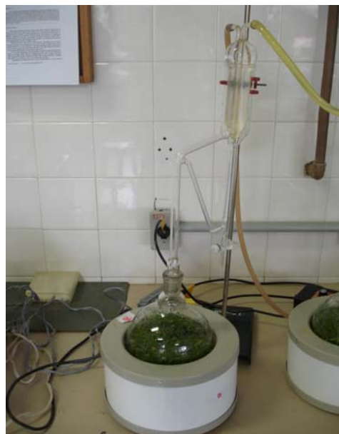
FIGURA 1 - Destilador tipo Clevenger do Laboratório de Ecofisiologia/UFPR. Curitiba-PR, 2006.
