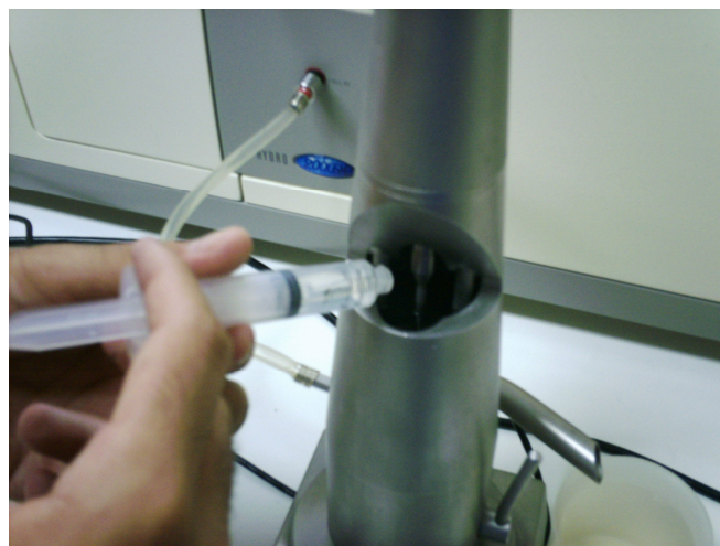
FIG. 3.4 Detalhe da deposição da amostra no porta-amostras da MALVERN
