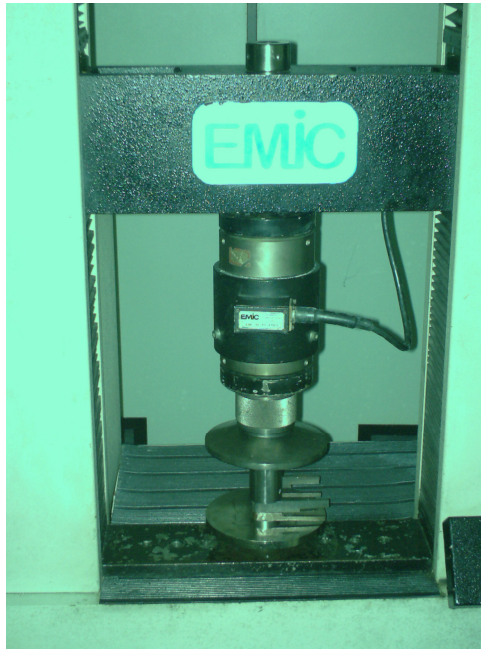
FIG. 3.10 Prensagem uniaxial na máquina universal de ensaios EMIC
