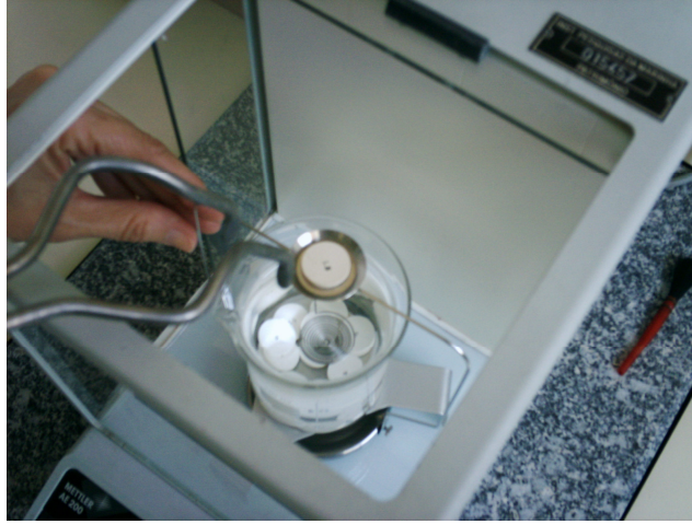
FIG. 3.12 Posicionamento da amostra na medida da massa úmida
