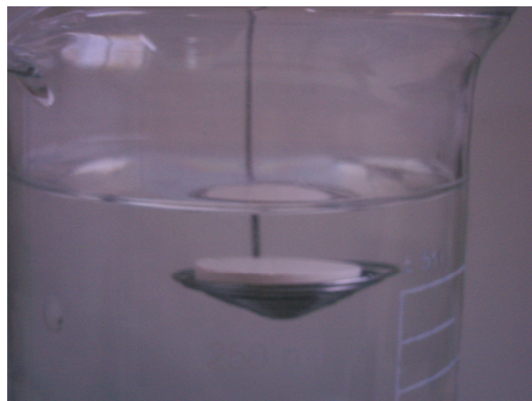
FIG. 3.11 Detalhe da amostra durante a medida de massa imersa
