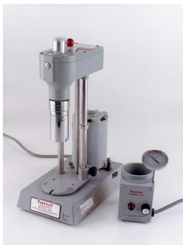
**FIG. 9.12 Viscosímetro Coaxial.**
