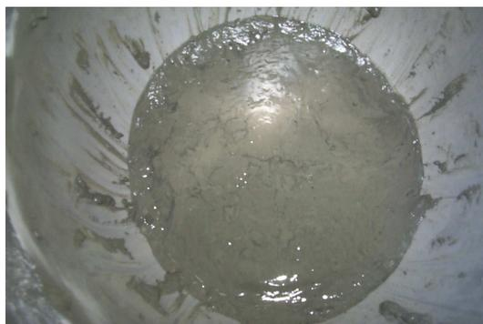
**FIG. 9.6** Ponto final do Procedimento de Demanda d'água
