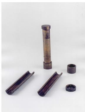
**FIG. 9.15 Molde para Ensaio de Estabilidade.**
