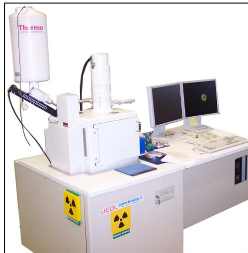
**FIG. 9.16 Microscópio Eletrônico de Varredura.**
