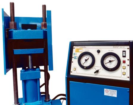
**FIG. 9.13 Prensa para Determinação de Resistência à Compressão.**
