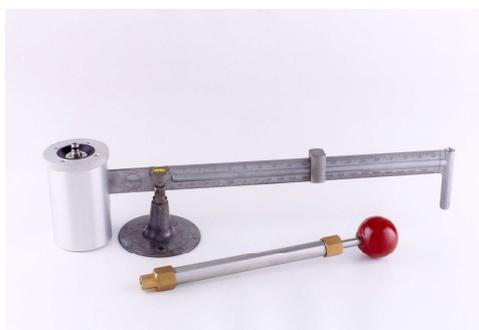
**FIG. 9.9 Balança de Lama Pressurizada.**
