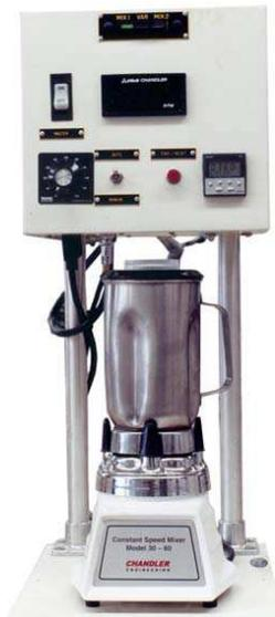
**FIG. 9.7 Misturador de Pasta de Cimento.**
