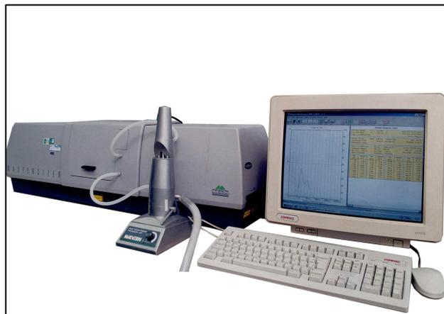
**FIG. 9.1 Granulômetro a Laser.**
