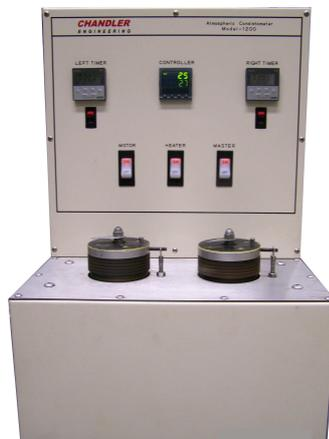
**FIG. 9.8 Consistômetro Atmosférico.**
