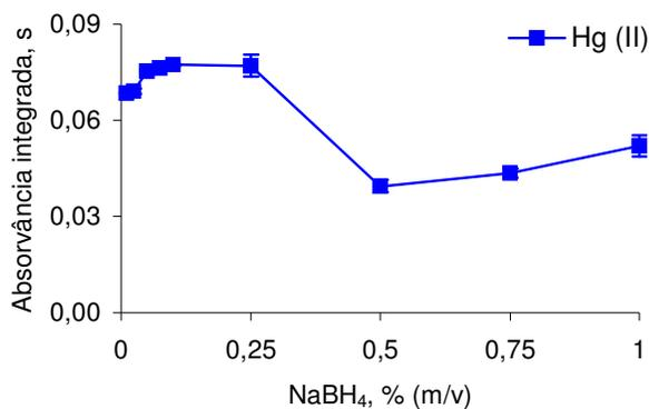
Figura 6. Influência da concentração do  $NaBH_4$  sobre a intensidade do sinal de Hg(II). Introdução de 2 mL de solução de Hg(II) a  $500 \text{ ng L}^{-1}$  em HCl  $1,0 \text{ mol L}^{-1}$  a  $10 \text{ mL min}^{-1}$  e vazão do redutor a  $2 \text{ mL min}^{-1}$ . Vazão de argônio de  $25 \text{ mL min}^{-1}$ .
