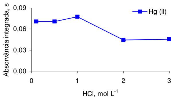
Figura 7. Influência da concentração de HCl sobre a intensidade do sinal do Hg(II). Introdução de 2 mL de solução de Hg(II) a  $500 \text{ ng L}^{-1}$  a  $10 \text{ mL min}^{-1}$  e  $\text{NaBH}_4$  de 0,1% (m/v) a  $2 \text{ mL min}^{-1}$ . Vazão de argônio a  $25 \text{ mL min}^{-1}$ .
