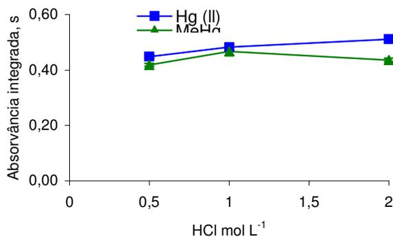
Figura 10. Influência da concentração de HCl na geração de vapor de Hg (Hg<sup>0</sup> e MeHgH) e retenção na coluna de Au. Introdução de 5 mL de solução de Hg(II) a 1000 ng L<sup>-1</sup> e 1000 ng L<sup>-1</sup> de MeHg (como Hg) a uma vazão de 10 mL min<sup>-1</sup>, NaBH<sub>4</sub> a 0,1% (m/v) com vazão de 2,0 mL min<sup>-1</sup>. Vazão de argônio de 25 mL min<sup>-1</sup>.
