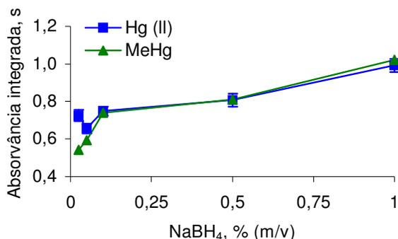
Figura 9. Influência da concentração de NaBH<sub>4</sub> na geração de vapor de Hg (Hg<sup>0</sup> e MeHgH) e retenção na coluna de Au. Introdução de 5 mL de solução de Hg(II) a 1000 ng L<sup>-1</sup> e 1000 ng L<sup>-1</sup> de MeHg (como Hg) em HCl 1,0 mol L<sup>-1</sup> a uma vazão de 10 mL min<sup>-1</sup>. Vazão de argônio de 25 mL min<sup>-1</sup> e vazão do redutor a 2,0 mL min<sup>-1</sup>.
