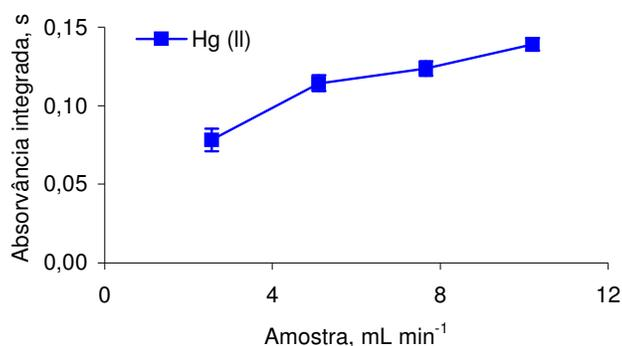
Figura 4. Influência da vazão da amostra sobre a intensidade do sinal do Hg(II). Solução de 500 ng L<sup>-1</sup> de Hg(II) em HCl 1,0 mol L<sup>-1</sup> e NaBH<sub>4</sub> a 0,05% (m/v). Vazão do NaBH<sub>4</sub> a 2,0 mL min<sup>-1</sup>. Vazão de argônio a 25 mL min<sup>-1</sup>.
