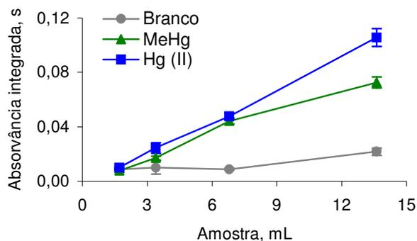
Figura 11. Influência do branco sobre a intensidade do sinal do Hg total para diferentes volumes de solução processados. Soluções de  $100 \text{ ng L}^{-1}$  de Hg(II) e  $100 \text{ ng L}^{-1}$  de MeHg em HCl  $1,0 \text{ mol L}^{-1}$  a  $10 \text{ mL min}^{-1}$  e  $\text{NaBH}_4$  a  $0,1\%$  (m/v) a  $2 \text{ mL min}^{-1}$  e vazão de argônio de  $25 \text{ mL min}^{-1}$ .
