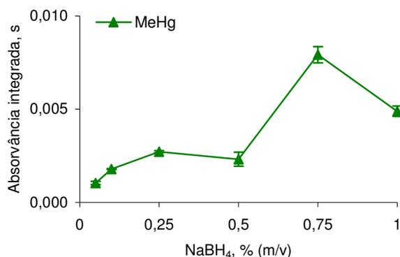
Figura 8. Influência da concentração de NaBH<sub>4</sub> na geração de Hg<sup>0</sup> a partir do MeHg. Introdução de 2 mL de solução de MeHg a 500 ng L<sup>-1</sup> (como Hg) em HCl 1,0 mol L<sup>-1</sup> a 10 mL min<sup>-1</sup>. Vazão de argônio de 25 mL min<sup>-1</sup> e vazão de NaBH<sub>4</sub> a 2,0 mL min<sup>-1</sup>.
