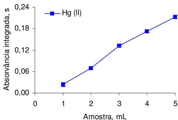
Figura 5. Influência do volume de amostra introduzida no sistema sobre a intensidade do sinal para Hg(II). Solução de  $500 \text{ ng L}^{-1}$  de Hg(II) em HCl  $1,0 \text{ mol L}^{-1}$  a  $10 \text{ mL min}^{-1}$  e  $\text{NaBH}_4$   $0,05\% \text{ (m/v)}$  a  $2,0 \text{ mL min}^{-1}$ . Vazão de argônio a  $25 \text{ mL min}^{-1}$ .
