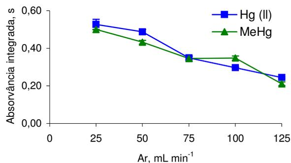
Figura 12. Influência da vazão de argônio sobre a intensidade do sinal do Hg total. 6,8 mL de solução 100 ng L<sup>-1</sup> de Hg (II) e 100 ng L<sup>-1</sup> de MeHg em HCl 1,0 mol L<sup>-1</sup> a 10 mL min<sup>-1</sup> e NaBH<sub>4</sub> a 0,1% (m/v) a 2 mL min<sup>-1</sup>.
