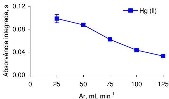
Figura 3. Influência da vazão de argônio sobre a intensidade do sinal para Hg(II). Solução de  $500 \text{ ng L}^{-1}$  de Hg(II) em  $\text{HCl } 1,0 \text{ mol L}^{-1}$  a  $10 \text{ mL min}^{-1}$  e  $\text{NaBH}_4$  0,05% (m/v) a  $2 \text{ mL min}^{-1}$ .
