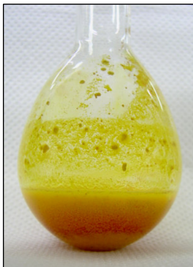
Figura 4. Digerido obtido após o preparo da amostra segundo o Método III da USP 30 para o cloridrato de amitriptilina.
