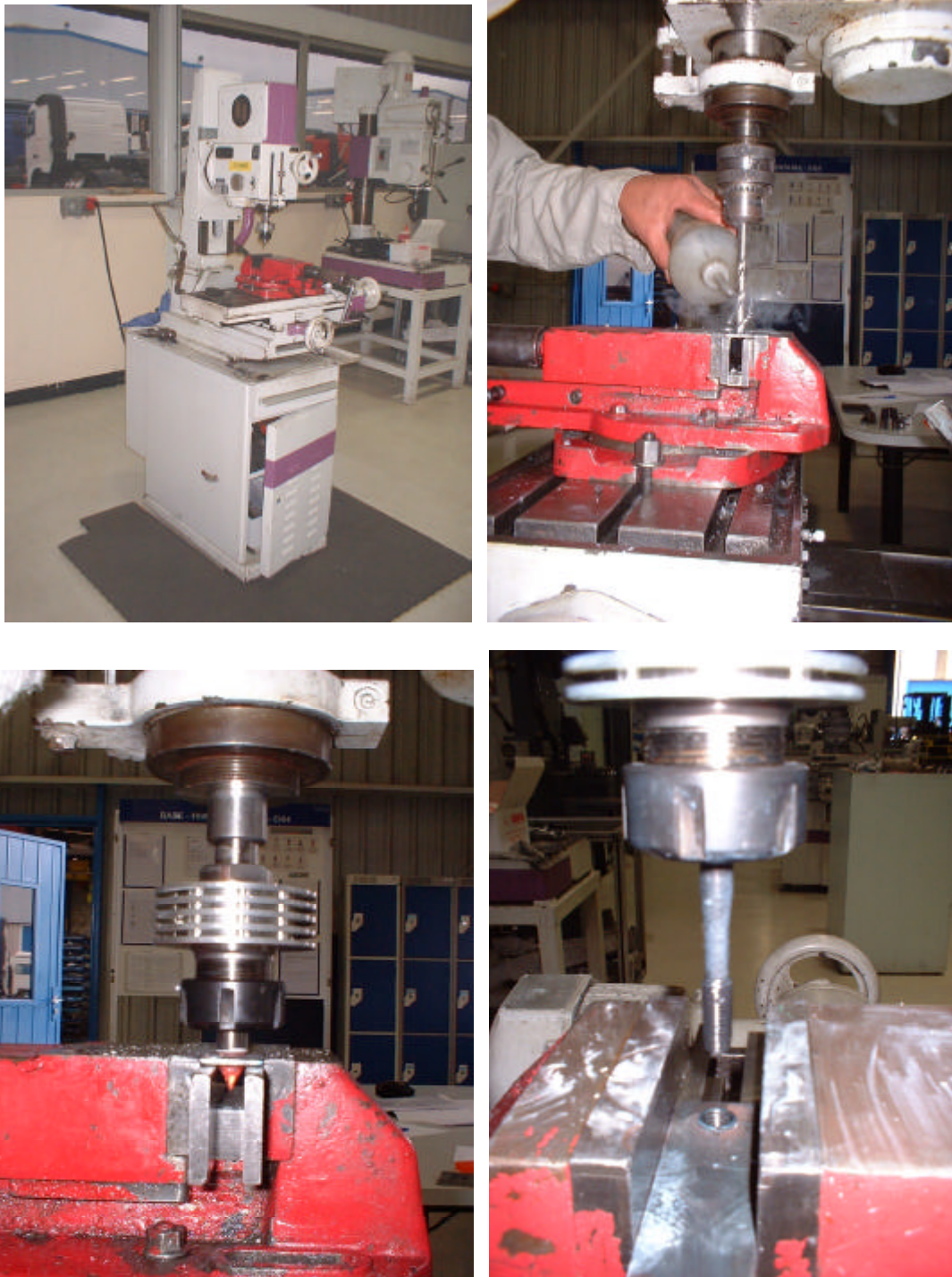
Figura 29 - Execução da furação por escoamento e convencional.
