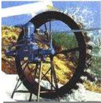
Figura 09 - Pequena central hidroelétrica (PCH) Fonte: NEA/ UFMA, 2007
