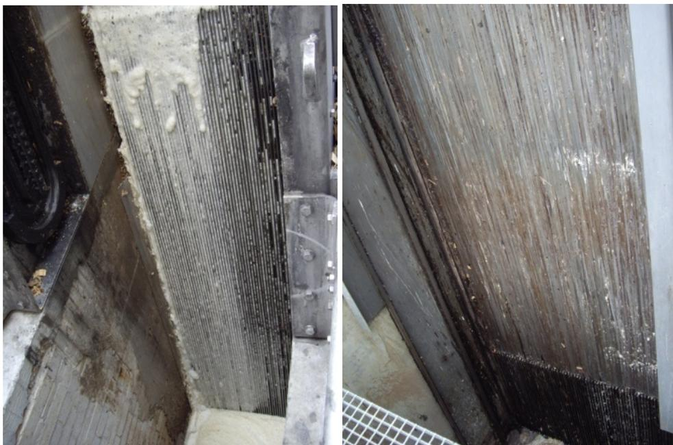
**Figura 14 – Sistemas de gradeamentos giratórios observados em visita técnica a fábricas de celulose localizadas na Europa (AMARAL, 2007).**
