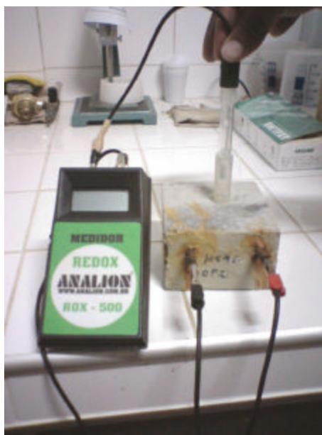
**Figura 74. Medição do potencial de corrosão.**
