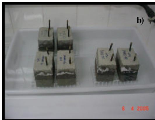
**Figura 72.** a) Etapa de secagem dos corpos-de-prova por 14 dias; b) Imersão parcial dos corpos-de-prova por 07 dias.
