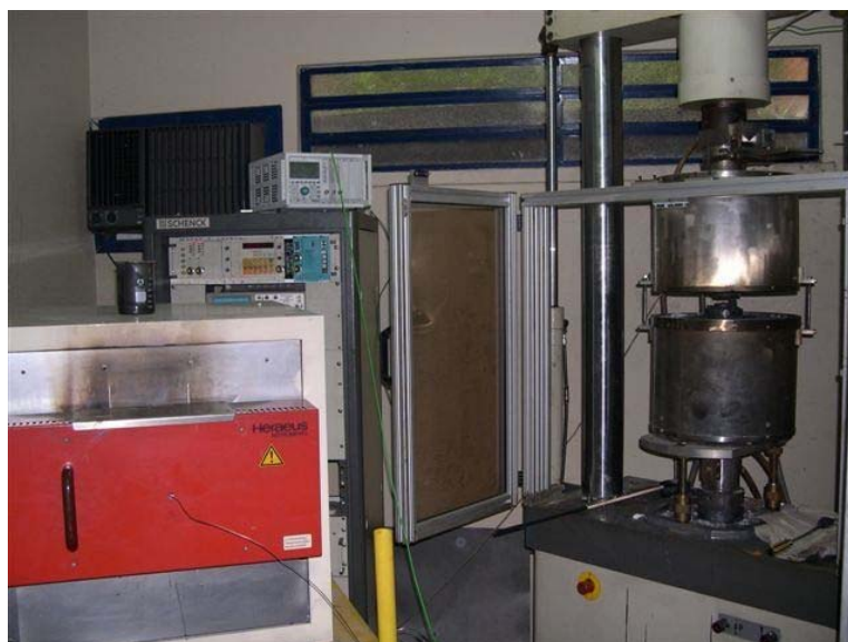
Figura 16: Conjunto para ensaio do anel, no LdTM da UFRGS. Forno, prensa e instrumentação.
