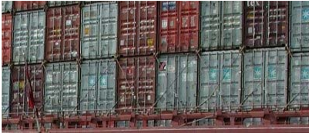
Figura 5.10 – Exemplo de amarração de container no deck (www.containerhandbook.de; 2005)
