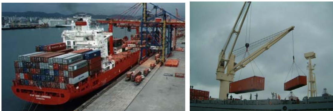
Figura 2.3 Movimentação de containers em portos utilizando guindastes (www.novomilenio.inf.br, 2005)
