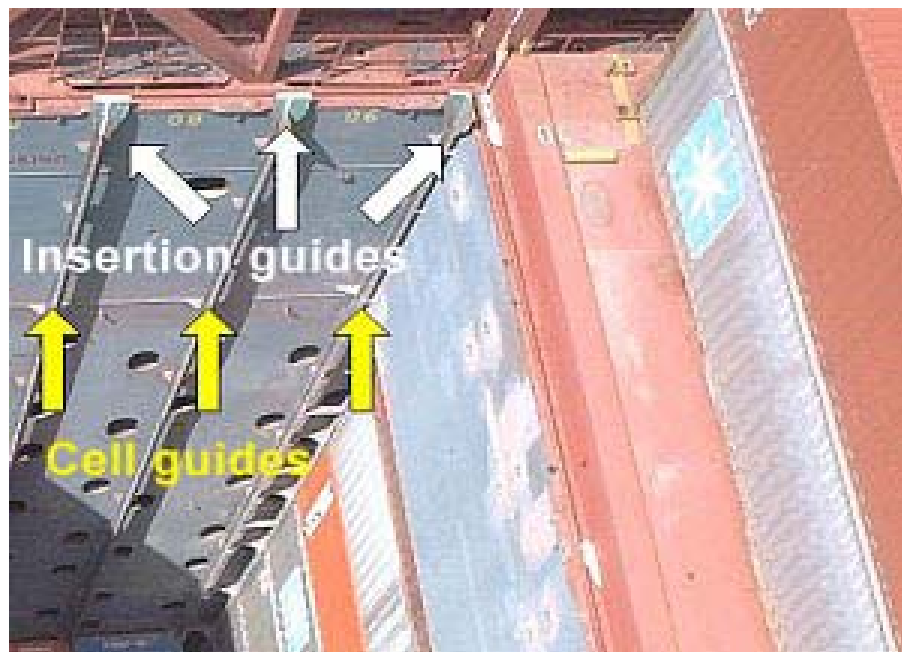
Figura 5.7 – Guias para carregamento de containers nos porões (www.containerhandbook.de; 2005)
