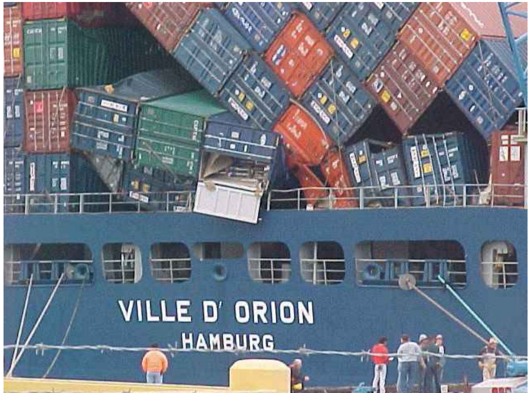
Fig 5.13 – Exemplo de colapso de pilha de containers no deck (GMB; 2005)
