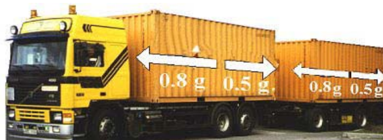
Figura 5.5 – Forças de aceleração longitudinal no transporte terrestre (www.containerhandbook.de; 2005)
