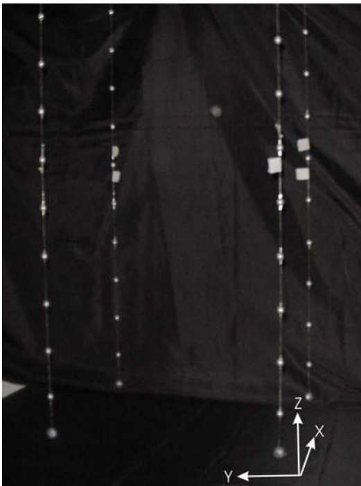
Figura 4: Volume usado para calibração do sistema de análise de imagens
