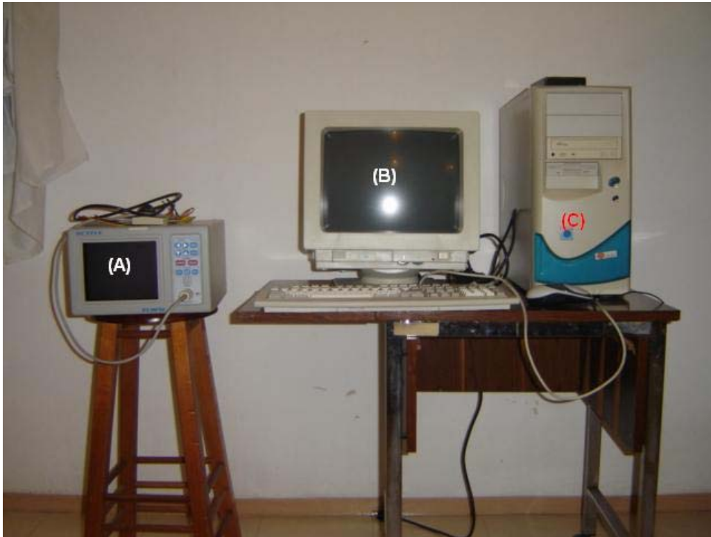
Figura 9. Ilustração do monitor cardíaco de um canal (A) utilizado para captação do ECG conectado a um microcomputador (C) e o monitor de vídeo (B)
