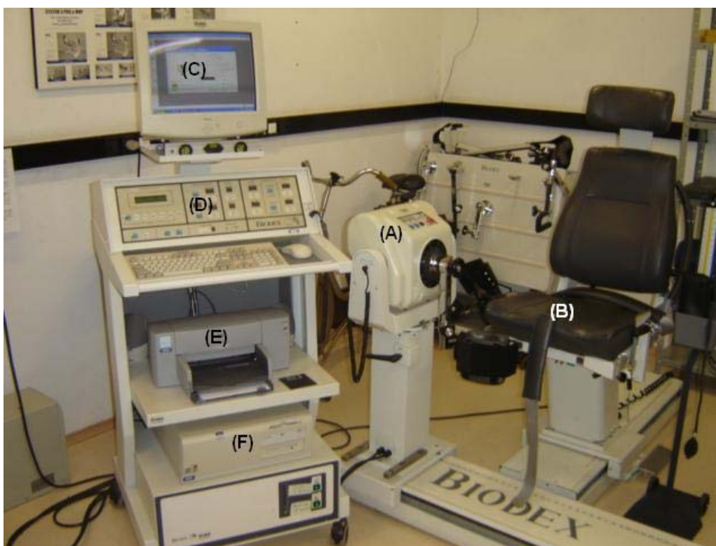
Figura 1. Ilustração do Biodesx composto por dinamômetro (A), cadeira (B), painel de controle (D) controlado por um microcomputador (F) conectado ao monitor de vídeo (C) e uma impressora (E).
