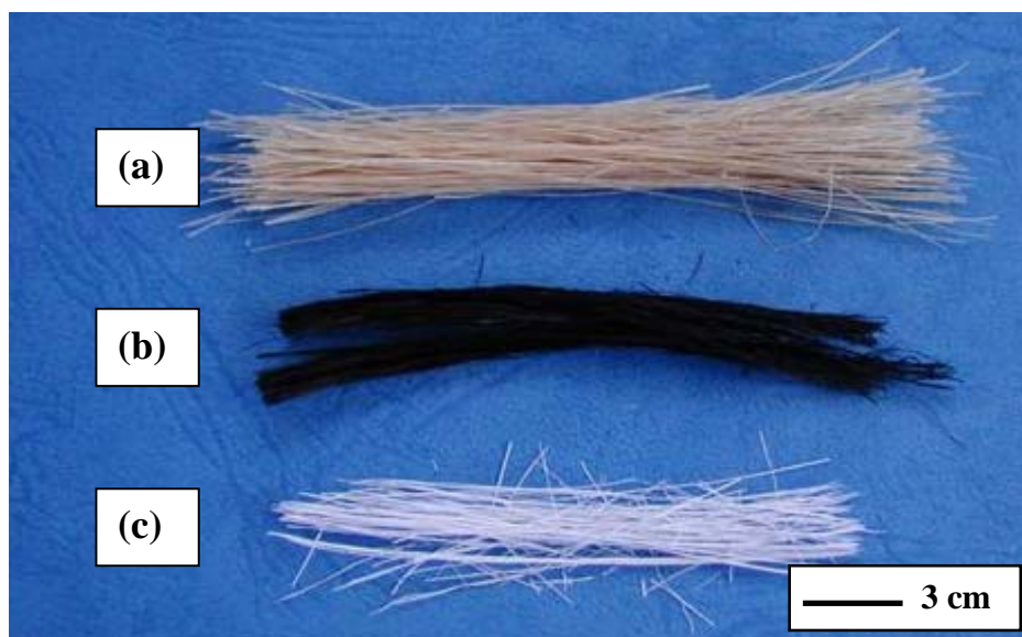
Figura 63 – Imagem digital das fibras de (a) sisal, (b) sisal pirolisado e (c) alumina.
