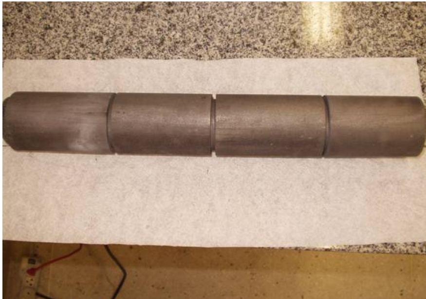
Figura 28 – Tubo de grafite utilizado na infiltração do Al-gas.
