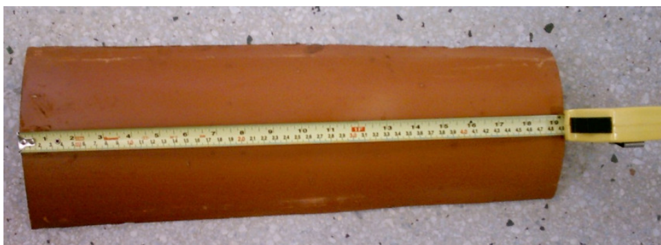
Figura 4.4 – Ensaio de dimensão de telha cerâmica.
