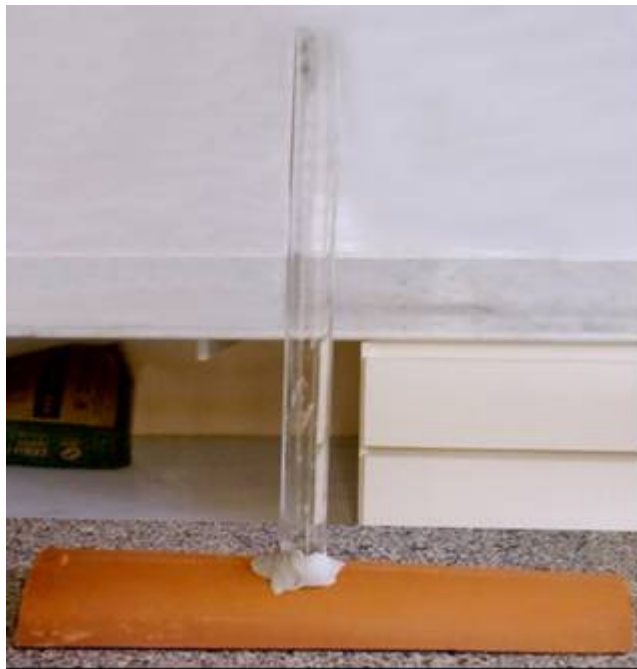
Figura 4.6 – Ensaio de impermeabilidade de telha cerâmica.
