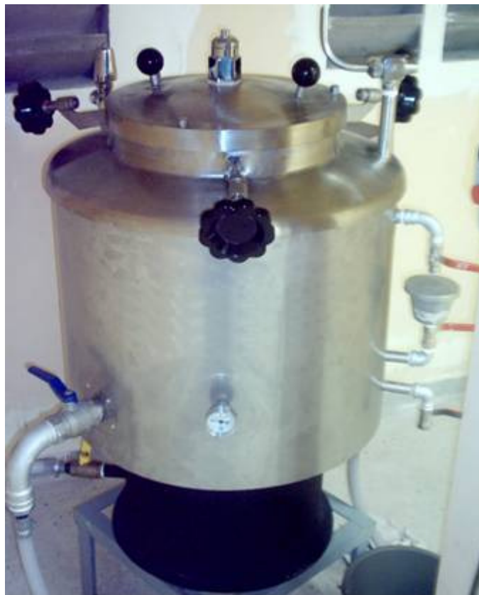
Figura 4.5 – Autoclave utilizado no ensaio de absorção de água.
