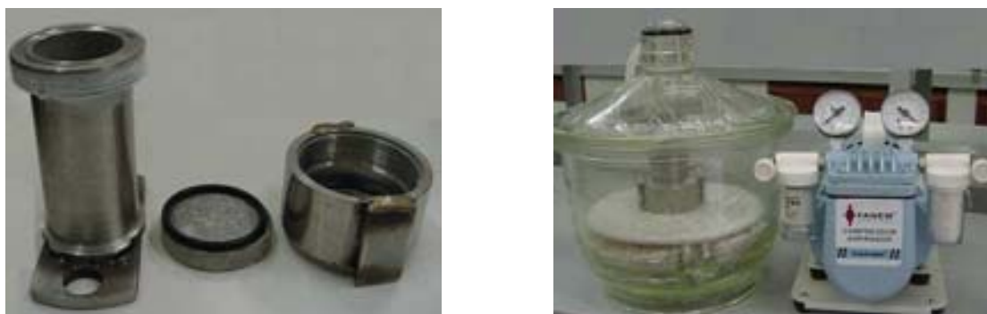
Figura 2.8- Aparato desenvolvido na UFRN para medir a permeabilidade em amostras de concreto.
