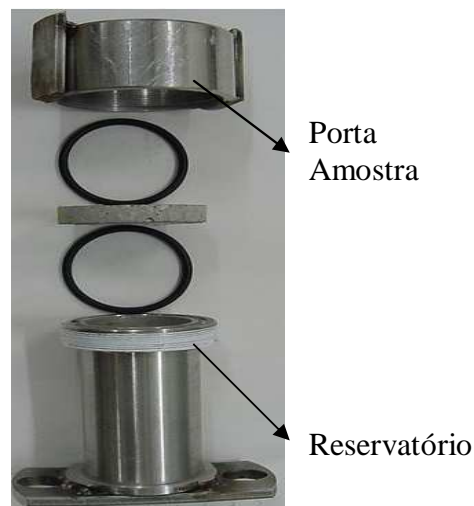
Figura 3.2- Representação da cela de permeabilidade.
