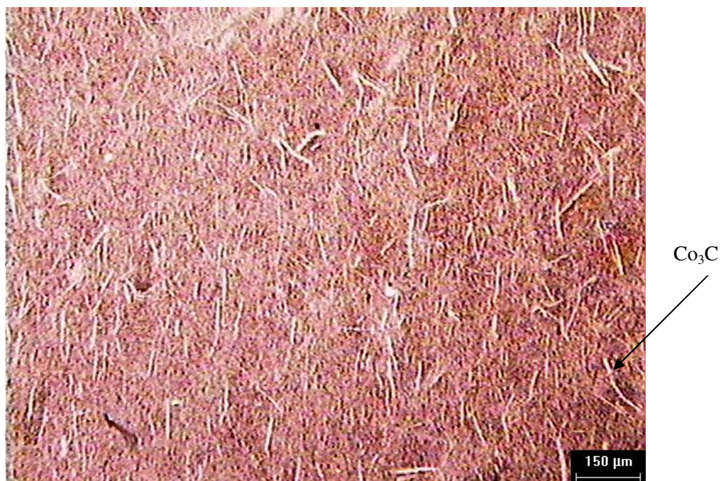
Figura 57. Micrografia (ótica 100x) do compósito sinterizado e moído por 300 horas.
