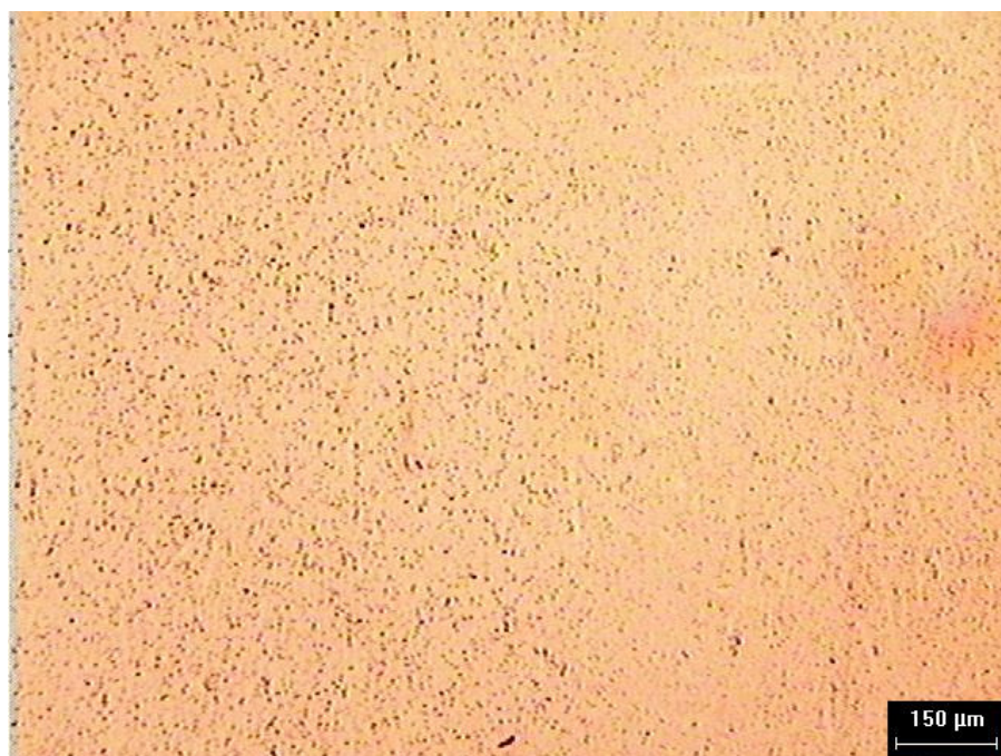
Figura 54. Micrografia (ótica 100x) do compósito sinterizado e moído por 2 horas.
