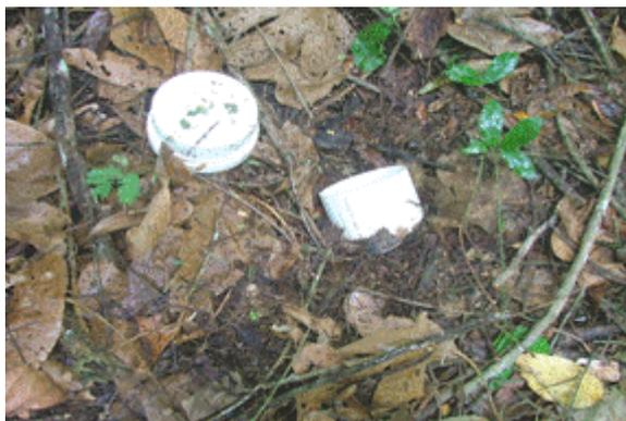
Figura 11- Coletor de água do solo
