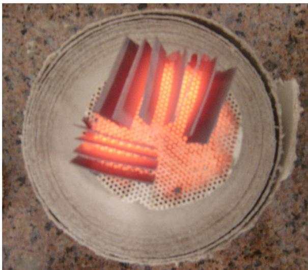
**Figura 13** Peças metálicas após a oxidação no forno.
