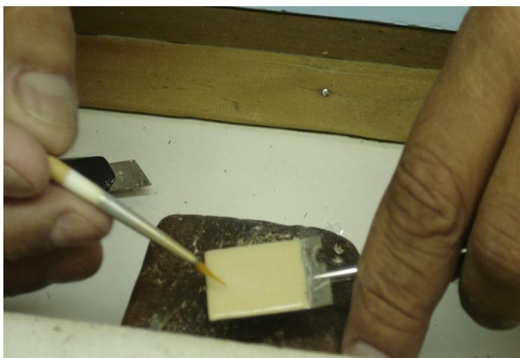
**Figura 14** Aplicação da cerâmica com auxílio de um pincel.
