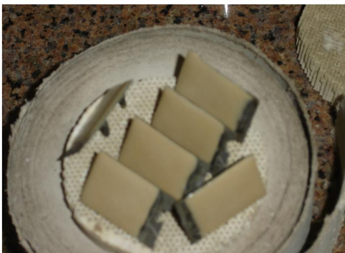
**Figura 15** Amostras metalocerâmicas logo após a sinterização da primeira camada de porcelana.
