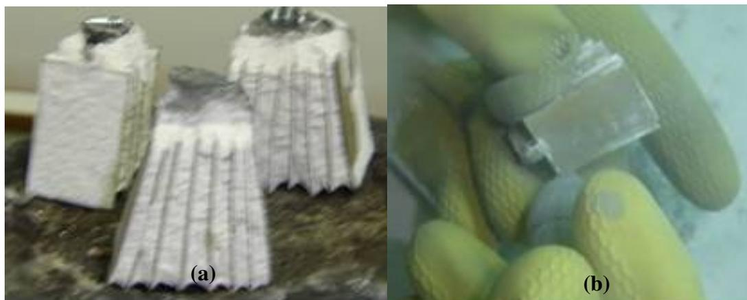
**Figura 8** Seqüência de limpeza das amostras, após retiradas do molde de revestimento. (a) Amostras após serem removidas do bloco de revestimento. (b) Limpeza das amostras com jato de alumina.
