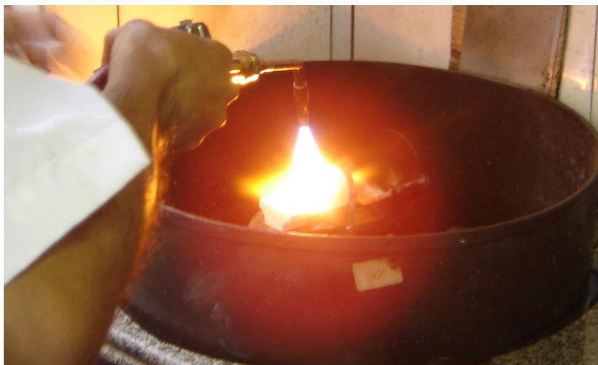
**Figura 11** Fundição do metal com o auxílio do maçarico.
