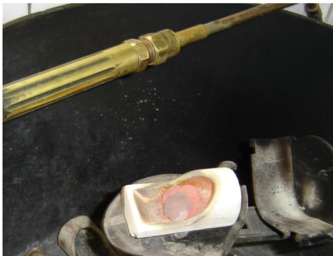
**Figura 10** Metal na centrífuga para ser fundido e depois introduzido no molde pré-fabricado.
