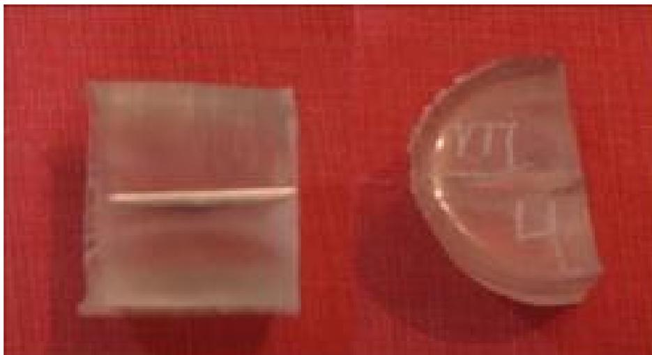
**Figura 17** Amostras embutidas e cortadas.
