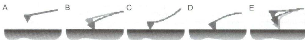
**Figura 9:** Posições do cantilêver durante a aproximação com a amostra. A - A sonda não toca a superfície. B - A sonda é atraída pela superfície. C - Após o contato o cantilêver é flexionado pela superfície. D - A amostra e a sonda estão se afastando, mas as forças de atração mantêm o cantilêver preso à superfície. E - A força elástica do cantilêver se torna superior às forças atrativas e o cantilêver se desprende da superfície.
