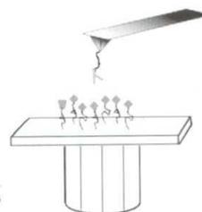
Figura 11: Receptor e ligante imobilizados na ponta de prova e no substrato por meio de *spacers* para medidas de força.
