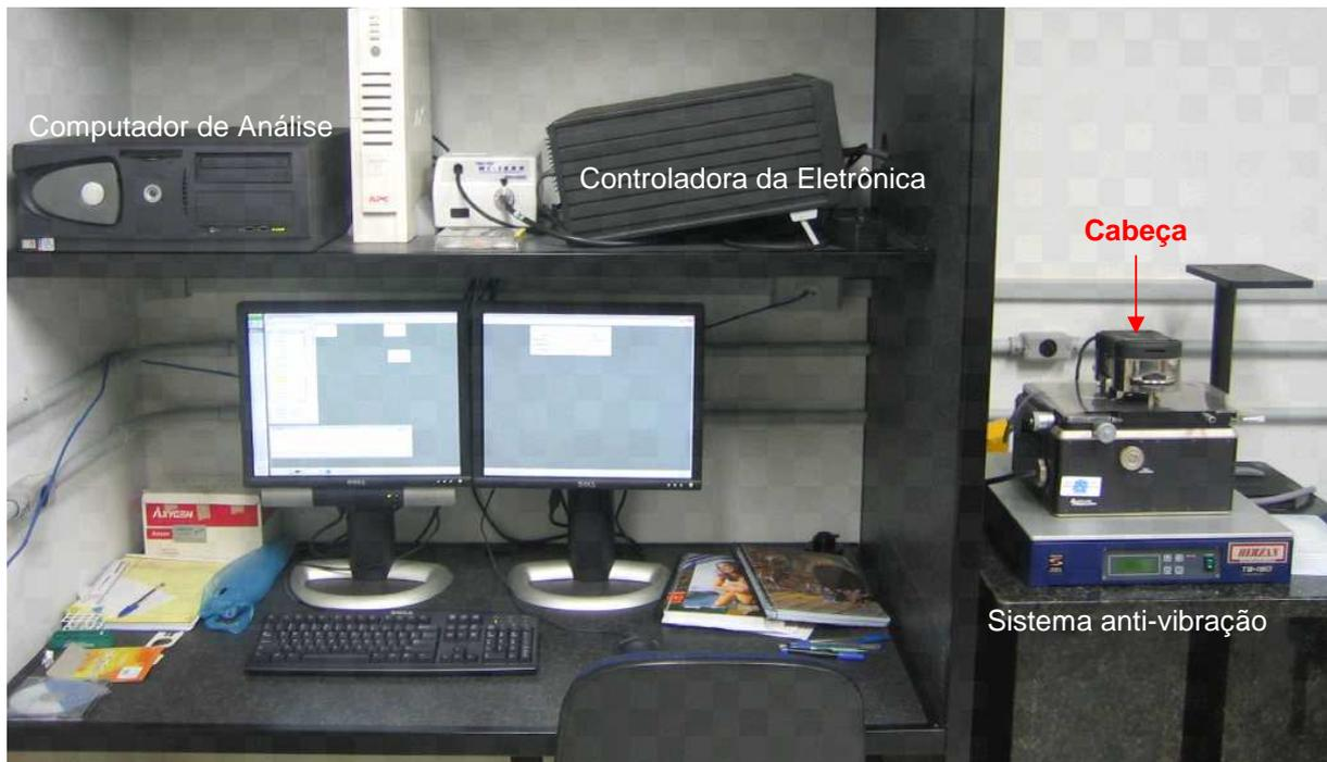
**Figura 3:** Foto do AFM utilizado nesse trabalho, mostrando todo o aparato computacional complementar, a controladora eletrônica e o sistema anti-vibração. A cabeça do equipamento é composta de três partes essenciais do microscópio.
