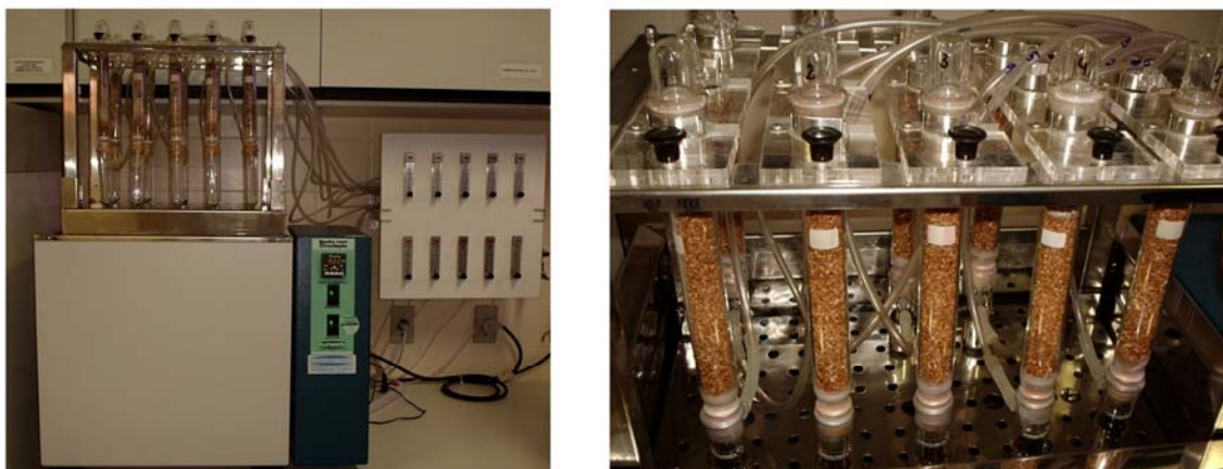
Figura 3.1 – Unidade experimental utilizada para a fermentação semi-sólida
