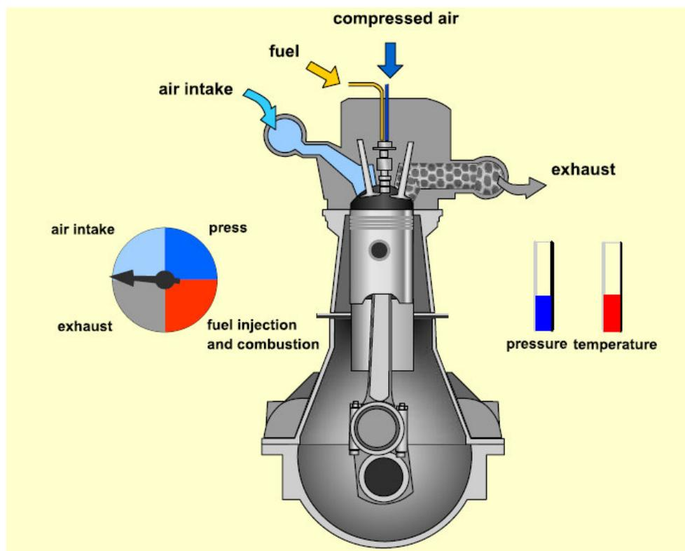
Figura 01. Esquema de funcionamento de um motor Diesel [4].
