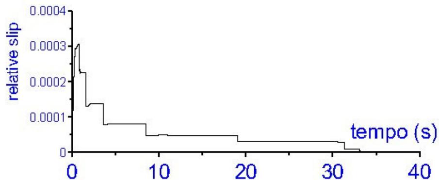
Figura 95. Gráfico da variação do escorregamento parcial do eixo dianteiro em função do tempo – Cenário 02.
