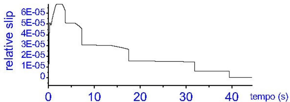
Figura 98. Gráfico da variação do escorregamento parcial do eixo dianteiro em função do tempo – Cenário 05.
