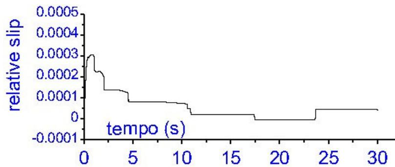
Figura 97. Gráfico da variação do escorregamento parcial do eixo dianteiro em função do tempo – Cenário 04.
