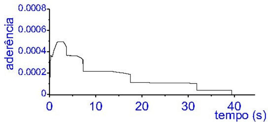
Figura 86. Gráfico da variação da aderência do eixo dianteiro em função do tempo – Cenário 05.
