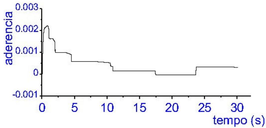
Figura 85. Gráfico da variação da aderência do eixo dianteiro em função do tempo – Cenário 04.
