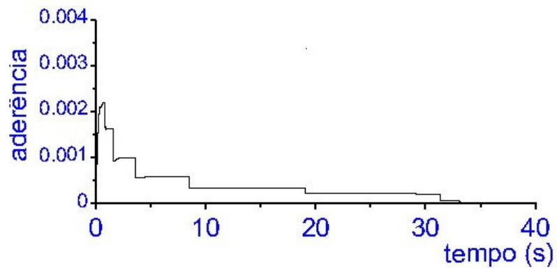
Figura 83. Gráfico da variação da aderência do eixo dianteiro em função do tempo – Cenário 02.
