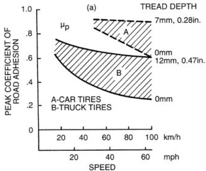
Figura 09. Comparação do coeficiente de adesão máxima  $\mu_p$  de pneus de automóveis e caminhões sobre piso molhado [20].
