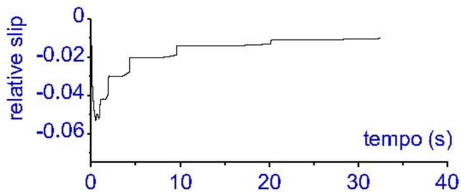
Figura 100. Gráfico da variação do escorregamento parcial do eixo traseiro em função do tempo – Cenário 01.
