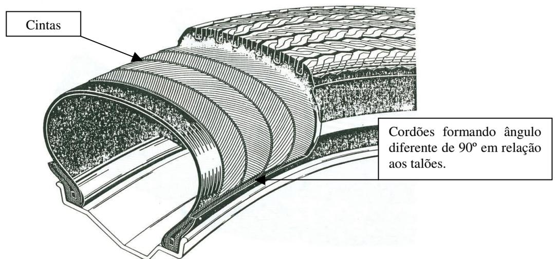
Figura 05. Exemplo de construção de um pneu diagonal [8].
