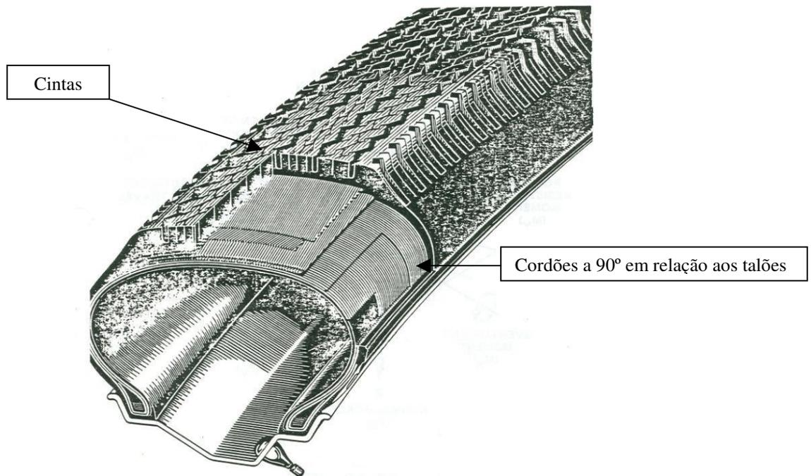
Figura 04. Exemplo de construção de um pneu radial [8].
