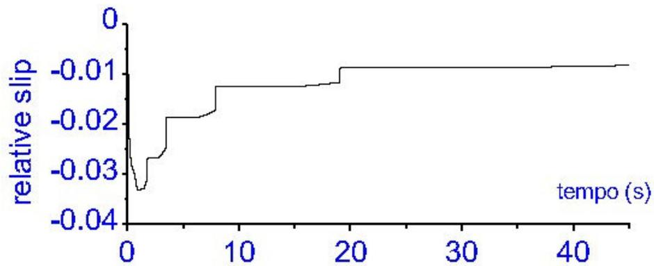
Figura 105. Gráfico da variação do escorregamento parcial do eixo traseiro em função do tempo – Cenário 06.
