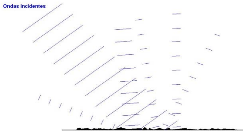
Figura 2.3: Reflexão difusa devido a rugosidade da superfície refletora.
