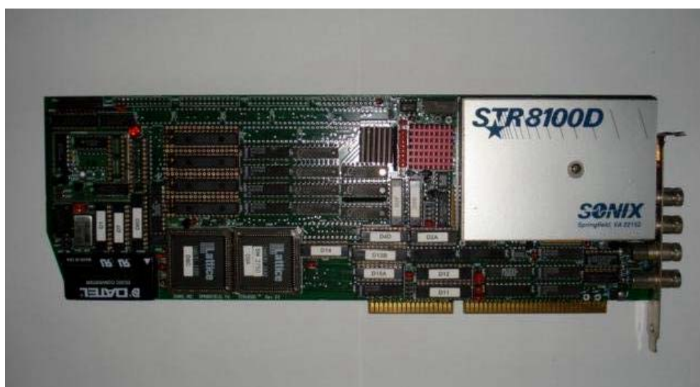
Figura 4.6: Foto da placa de aquisição de sinal ultra-sônico STR8100D.
