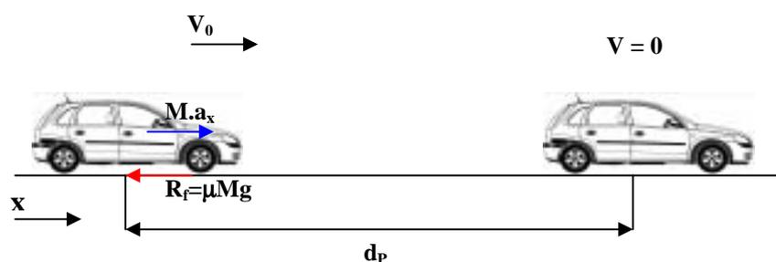
Fig. 5.4 – Veículo em frenagem: Diagrama simplificado de forças
