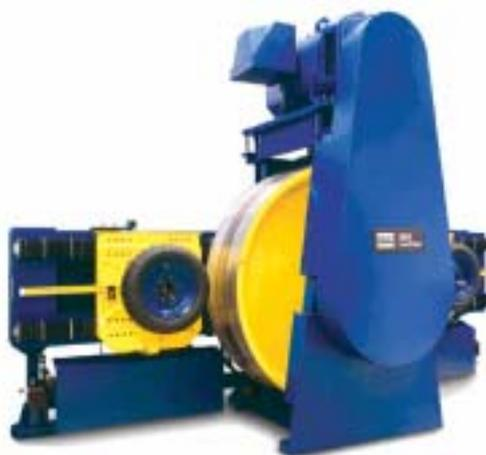
Fig. 4.2 - Equipamento para teste de resistência à velocidade e à carga MTS Road Wheel 860 [41]
