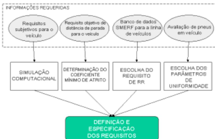
Fig. 6.2 – Fluxograma do processo até a consolidação dos requisitos de desempenho
